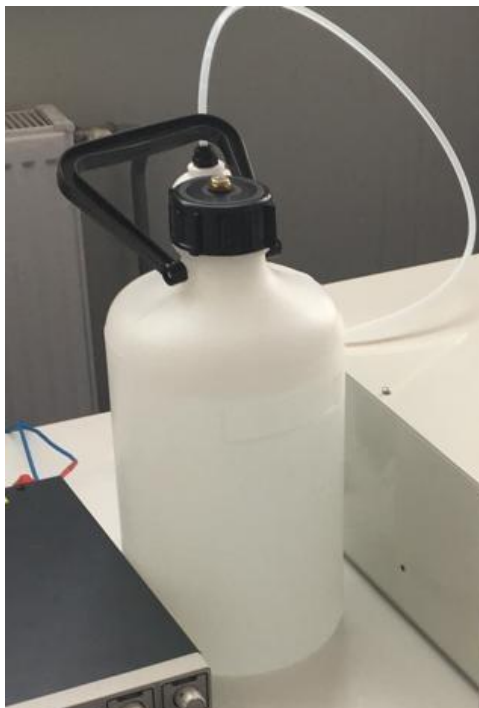
Slika 25. Unutarnji spremnik vode sa sustavom finog pročišćivanja
