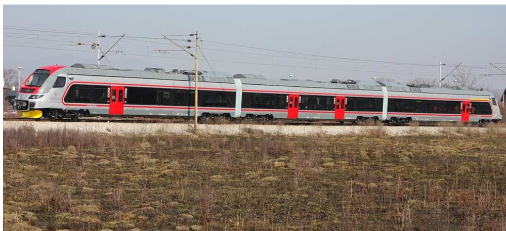
Slika 18. HŽ DMV („dizel – motorni vlak“) serije 7022 sastoji se od tri modula („motornih vagona“) od kojih je središnji modul pogonski, a rubni moduli su upravljački, s tri Dieselova motora snage 588 kW, pripada kategoriji RLR-v-1 [22],[23],[24]
