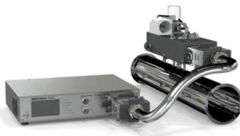
Slika 28. Semtech-FEM integrirani sustav NDIR + EFM
