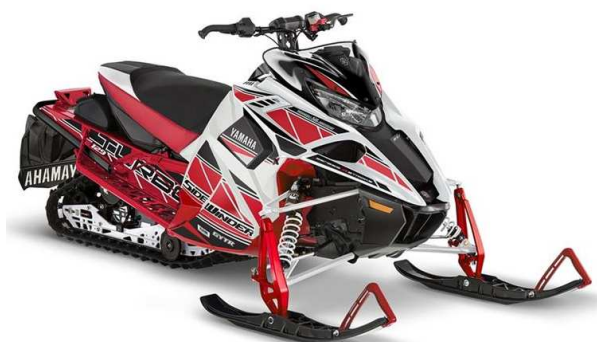
Slika 19. Motorne saonice Yamaha Sidewinder R□TX LE 50th, mase oko 300 kg [25]
