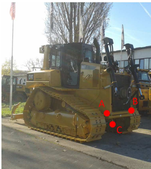
Slika 72. Mjesta prihвата nosača na prednjem dijelu stroja
