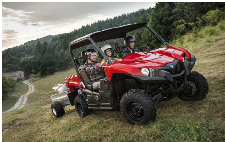
Slika 23. Primjer SbS vozila kod kojeg se mogu vidjeti osnovne karakteristike koje razlikuju takvo vozilo od ATV-a. SbS vozilo posjeduje upravljač umjesto ručaka za upravljanje, njime je moguće prevoziti osobe i robu, konstruirano je i za gospodarske svrhe [29]
