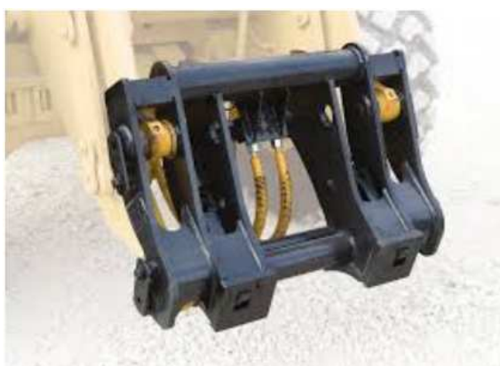
Slika 80. Spojka za radni alat s prednje strane
