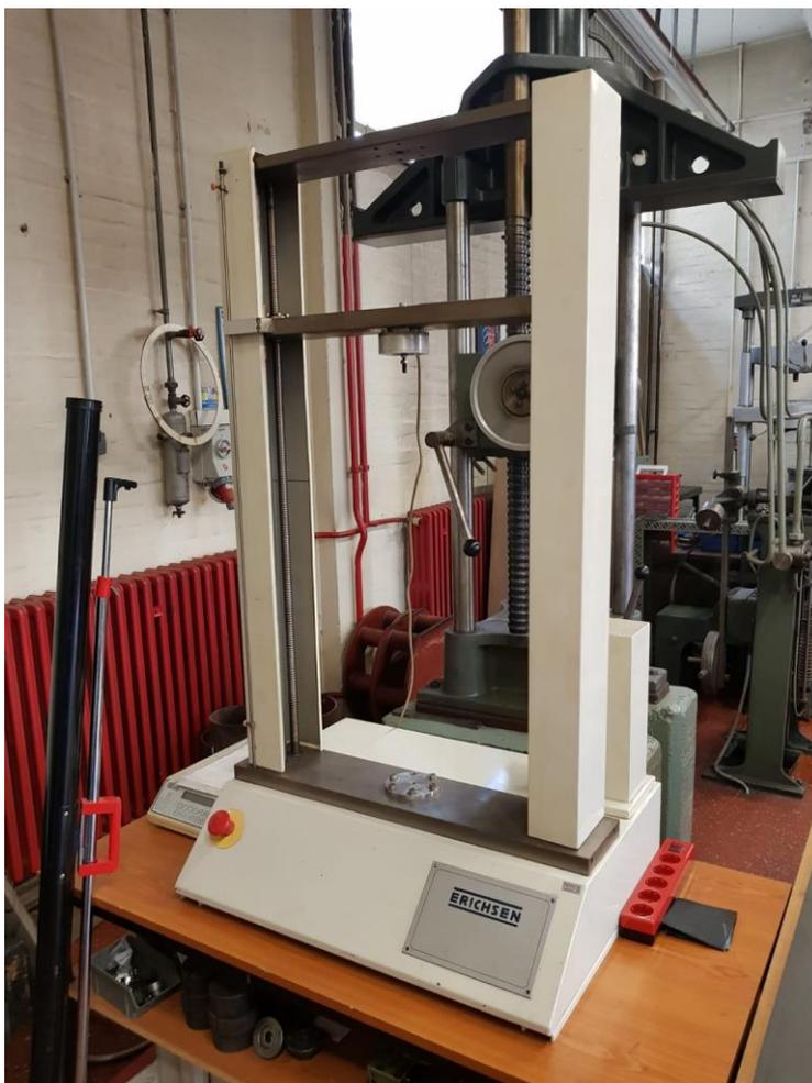
Slika 14. Kidalica u Laboratoriju za ispitivanje mehaničkih svojstava
