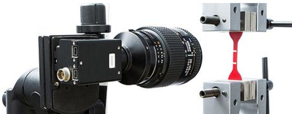
Slika 6. Suvremeni video ekstenzometar [13]
