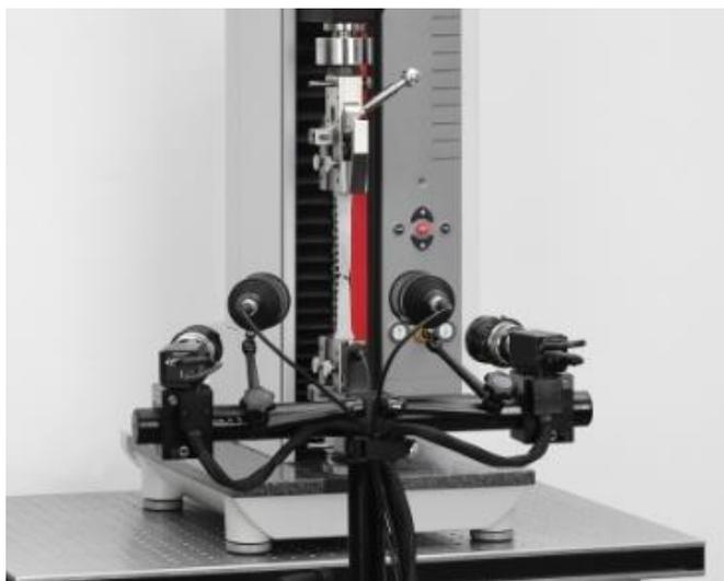
Slika 4. Moderni optički ekstenzometar [13]
