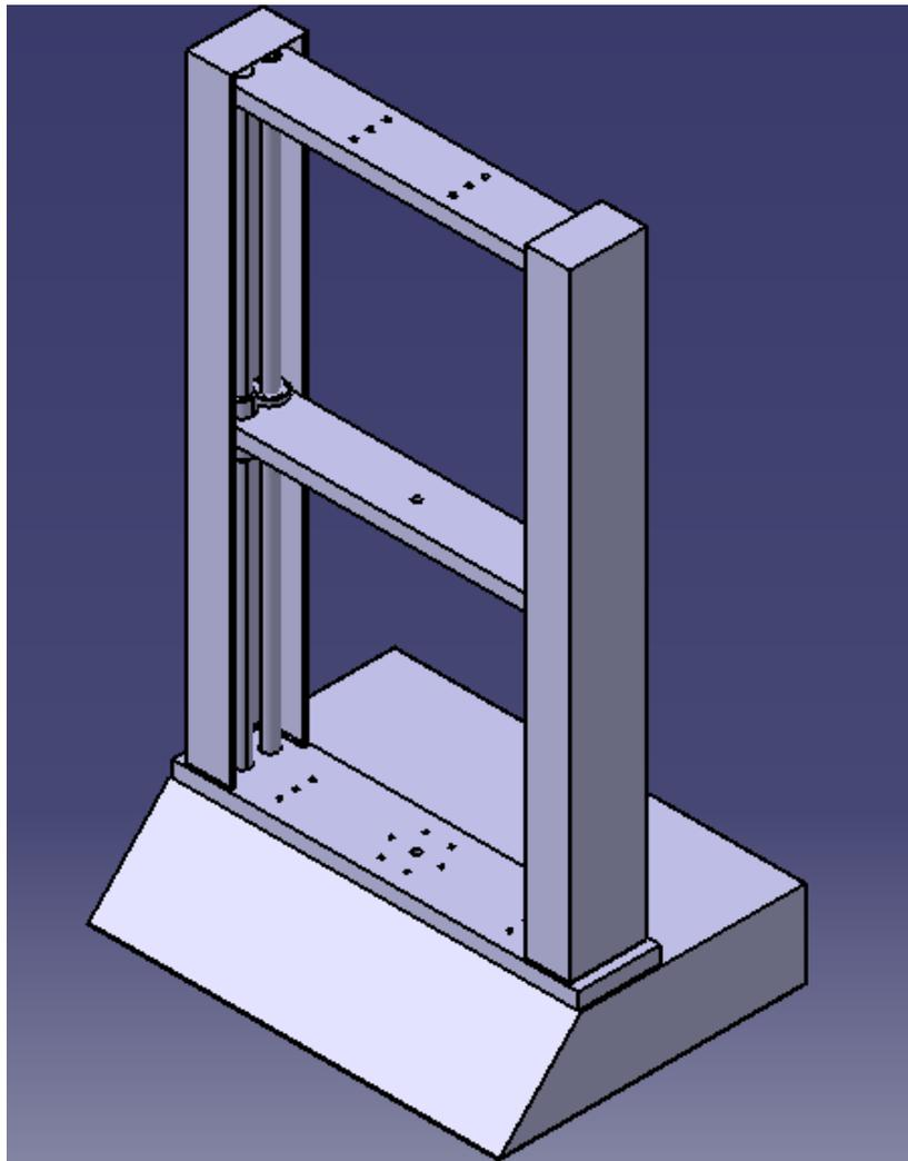
Slika 15. 3D model postojeće kidalice u laboratoriju
