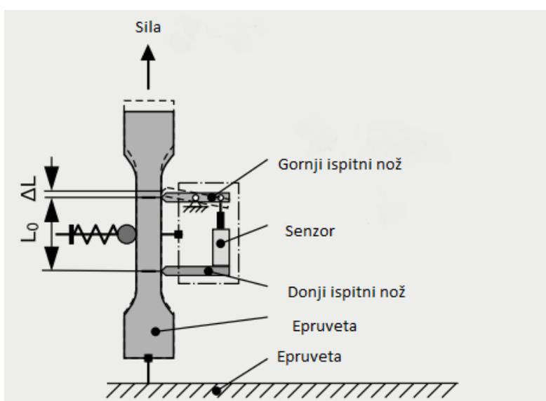
Slika 3. Mehanički ekstenzometar [8]
