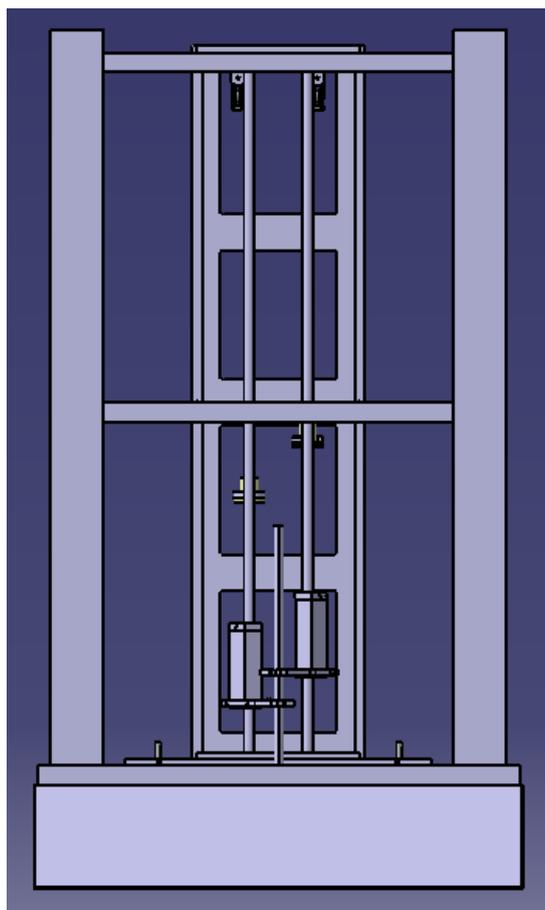
Slika 40. Nacrt kidalice
