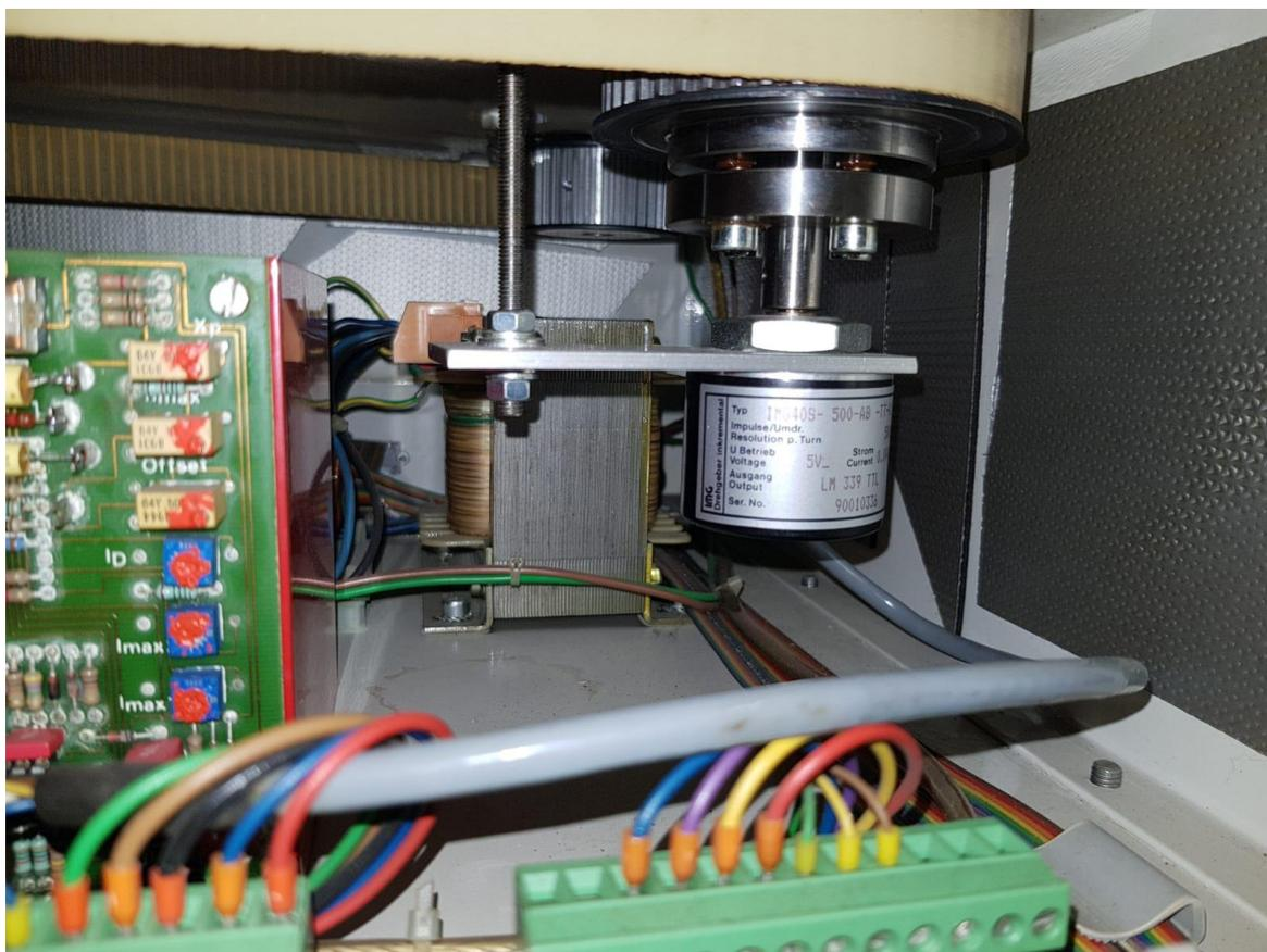
Slika 19. Unutrašnjost kućišta kidalice
