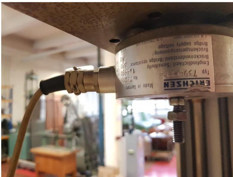
Slika 16. Senzor sile montiran na pokretnu traverzu
