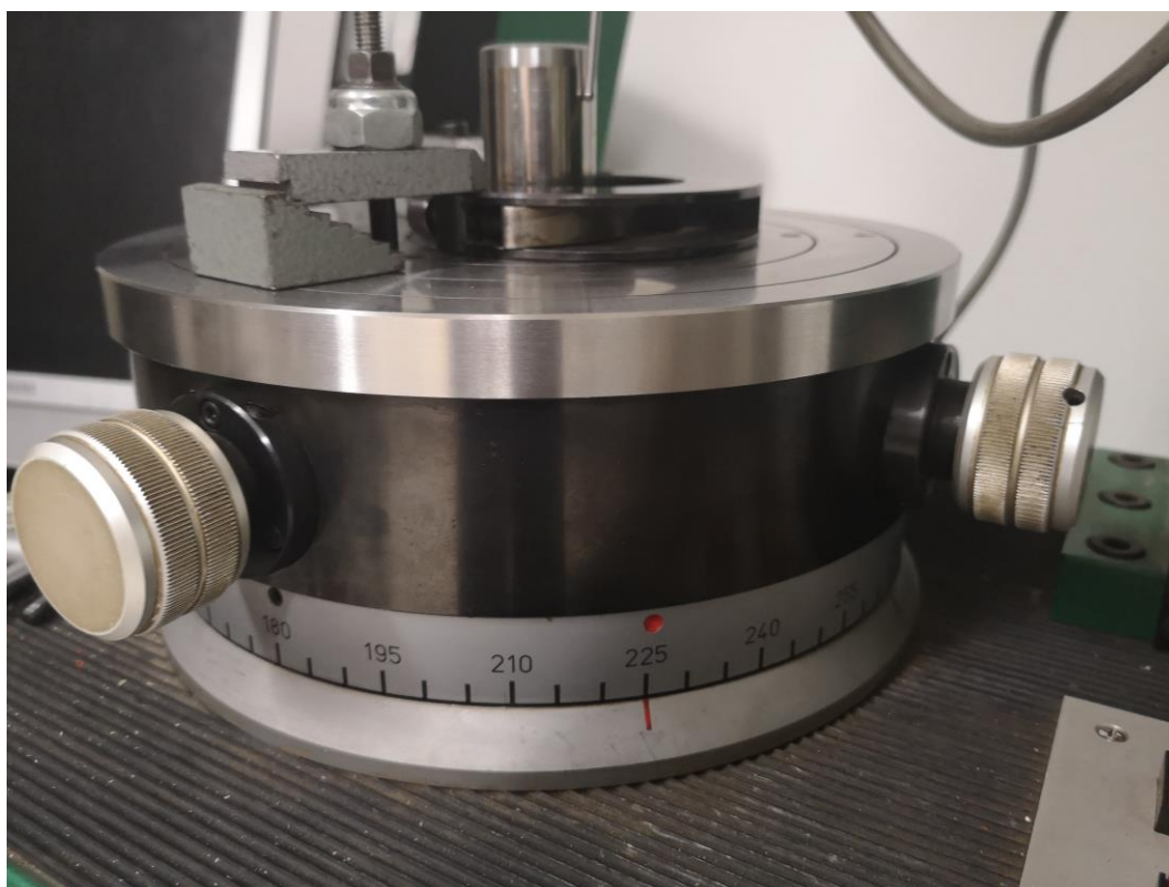
Slika 37. Početni položaj mjerenja „Two-position“ metode
