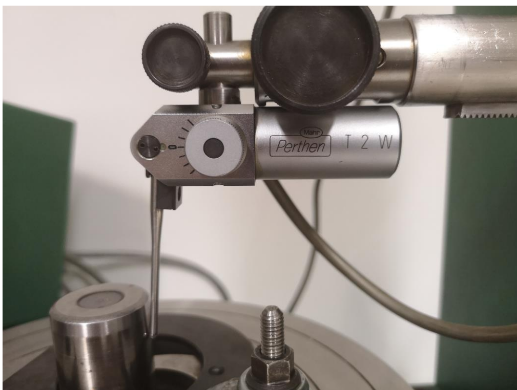
Slika 28. Induktivno ticalo na uređaju za mjerenje kružnosti
