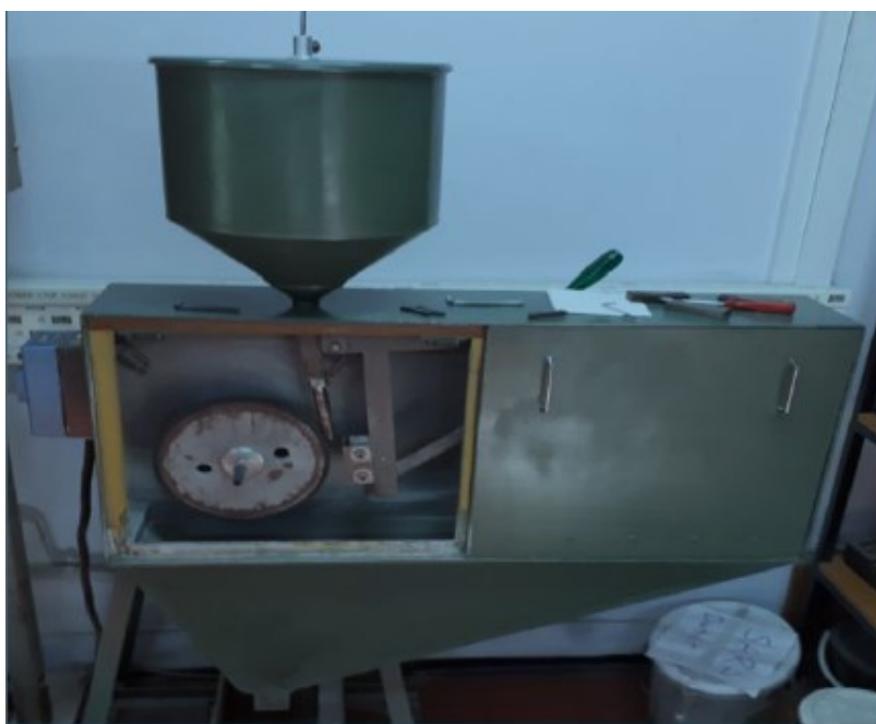
Slika 20. Uređaj za ispitivanje otpornosti na abrazijsko trošenje [7]
