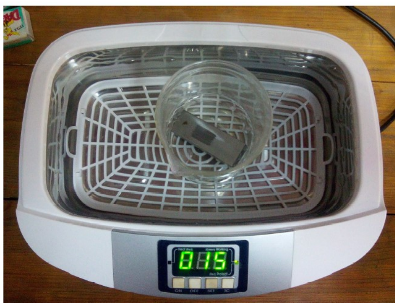
Slika 39. Čišćenje ispitnog uzorka u ultrazvučnoj kupki
