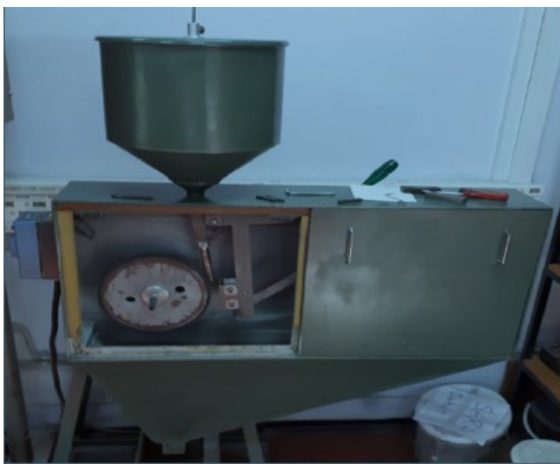
Slika 20. Uređaj za ispitivanje otpornosti na abrazijsko trošenje [7]
