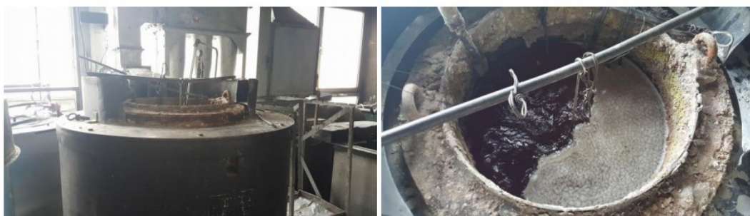
Slika 24. Solna kupka za nitriranje postupkom TENIFER [18]
