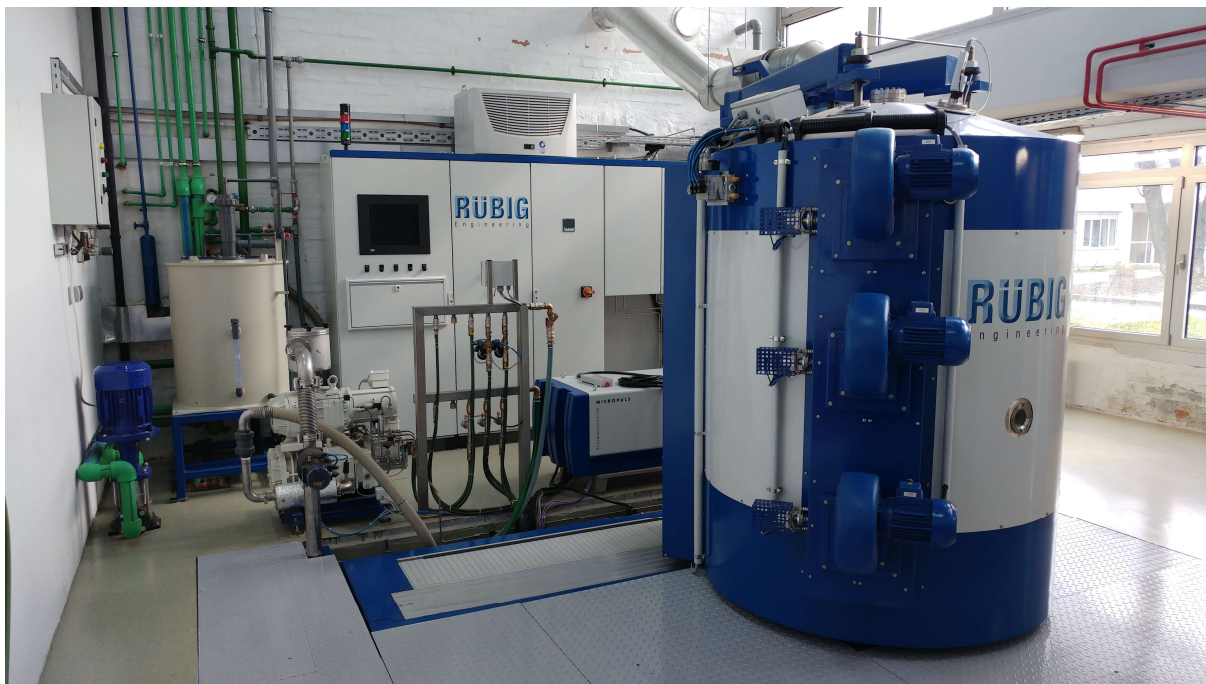
Slika 26. Uređaj za plazmatsko nitriranje i prevlačenje Rübigen PC 70/90
