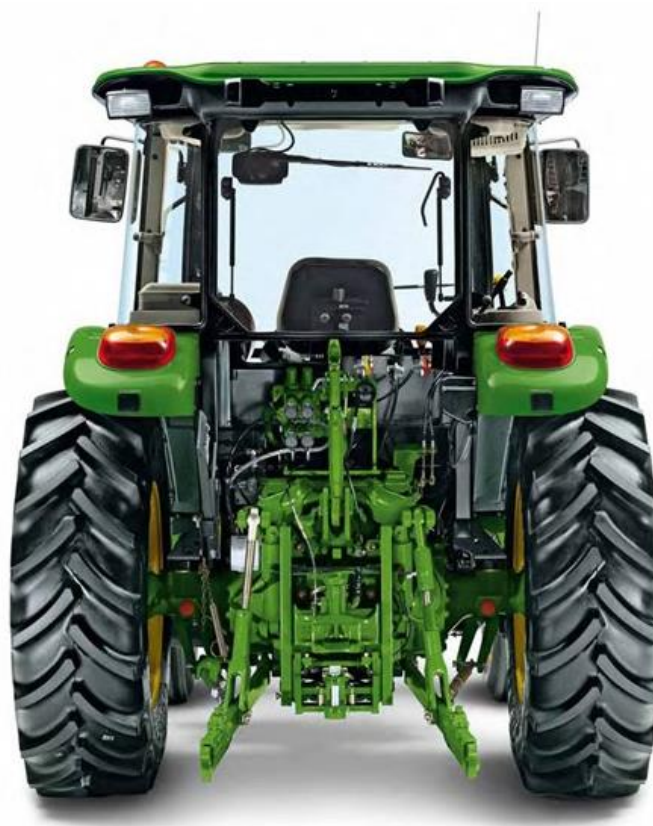
Slika 5. Pozicija poteznice na traktoru
