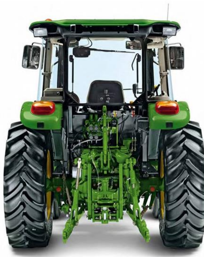
Slika 5. Pozicija poteznice na traktoru
