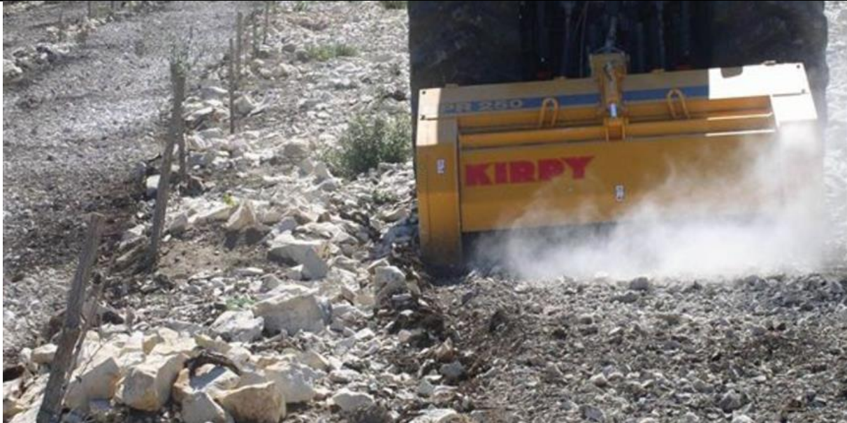
Slika 2. Postupak usitnjavanja kamena
