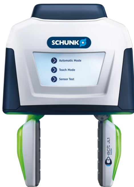
Slika 7. Schunk-ova kolaborativna hvataljka Co-act JLI [6]
