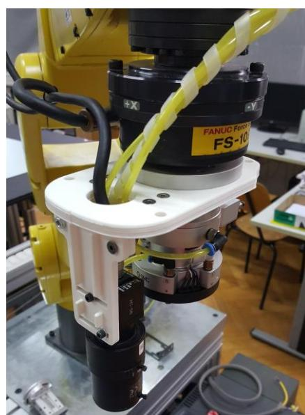
Slika 24. Prirubnica pričvršćena na adaptersku ploču robota
