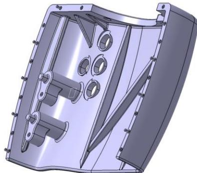
**Slika 27. Pogled na dodatne značajke za unutarnji spoj vijcima i protiv savijanja prilikom držanja rukom**
