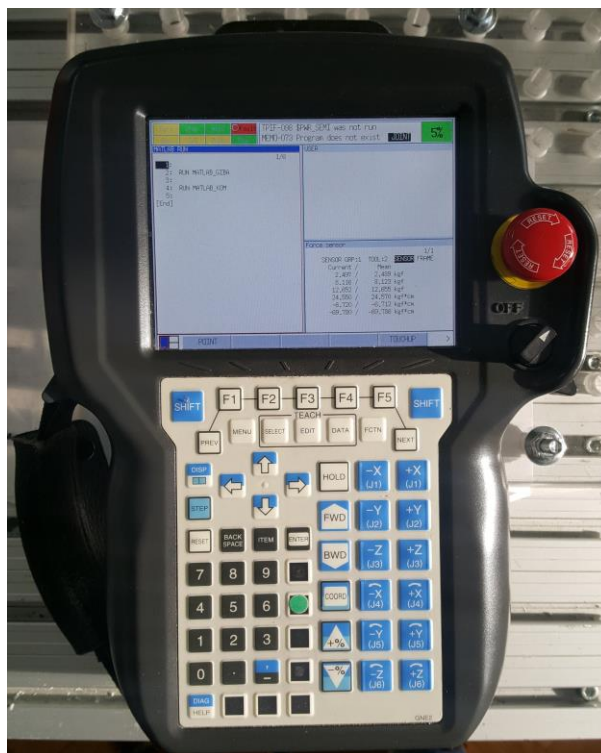
Slika 14. Upravljačka konzola (eng. Teach Pendant )
