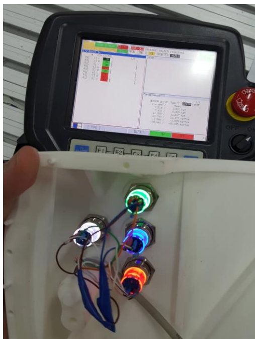
Slika 39. Provjera signala i LED dioda
