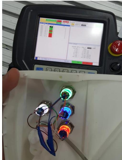
**Slika 39. Provjera signala i LED dioda**
