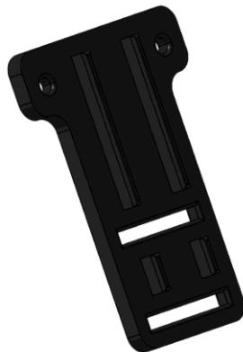
**Slika 33. Model pločice za kameru**
