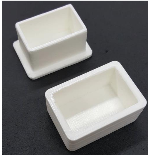
Slika 51. Isprintani 3D modeli kutije i poklopca
