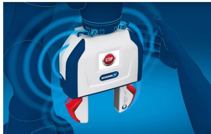
**Slika 8.** Detekcija kolizije kapacitivnim senzorom
