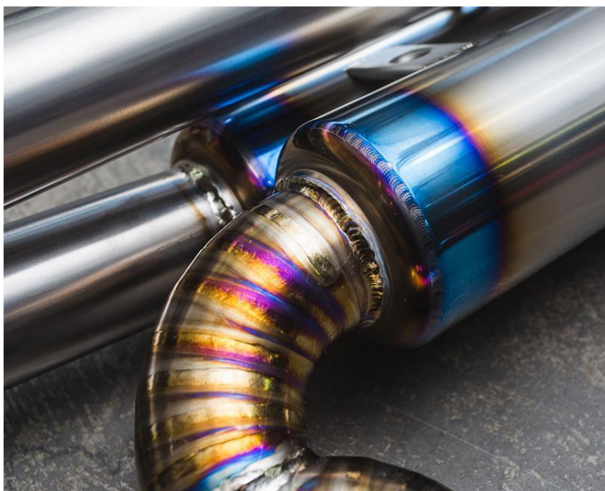
Slika 4.1. Zavarivanje titanijevog ispušnog sustava [27]
