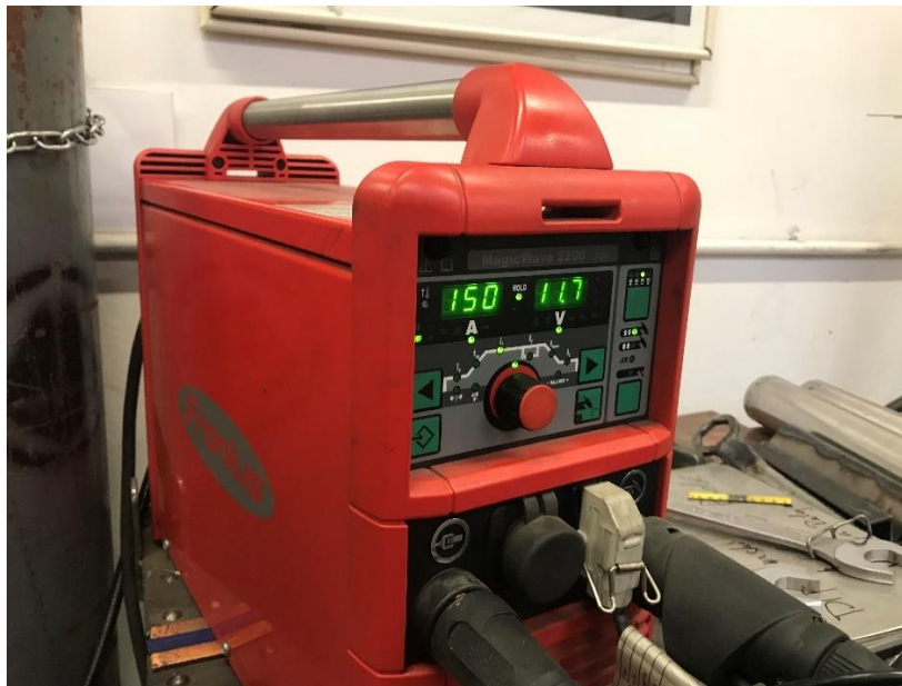
Slika 6.11. TIG uređaj Magic Wave 2000
