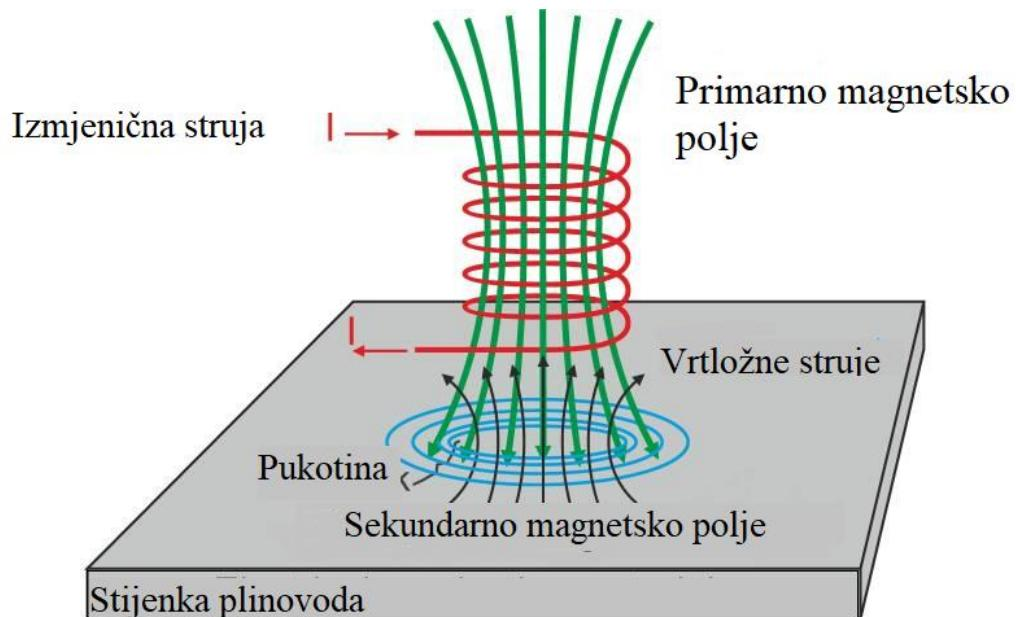
**Slika 8. Princip rada vrtložnih struja [12]**
