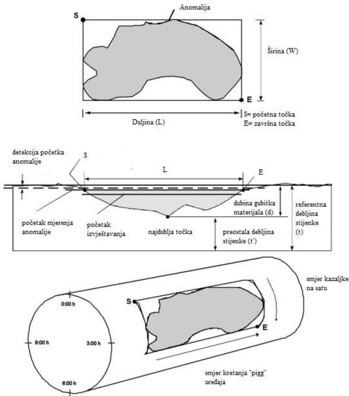
**Slika 9. Podaci o lokaciji anomalije dobivenih in-line inspekcijom [13]**
