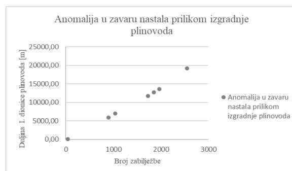
**Slika 15. Broj zabilježbi anomalija u zavaru nastalih prilikom izgradnje plinovoda po duljini I. dionice plinovoda [m]**
