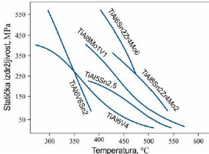
**Slika 3:** Statička izdržljivost nakon 150 sati opterećenja za odabране Ti-legure [1]
