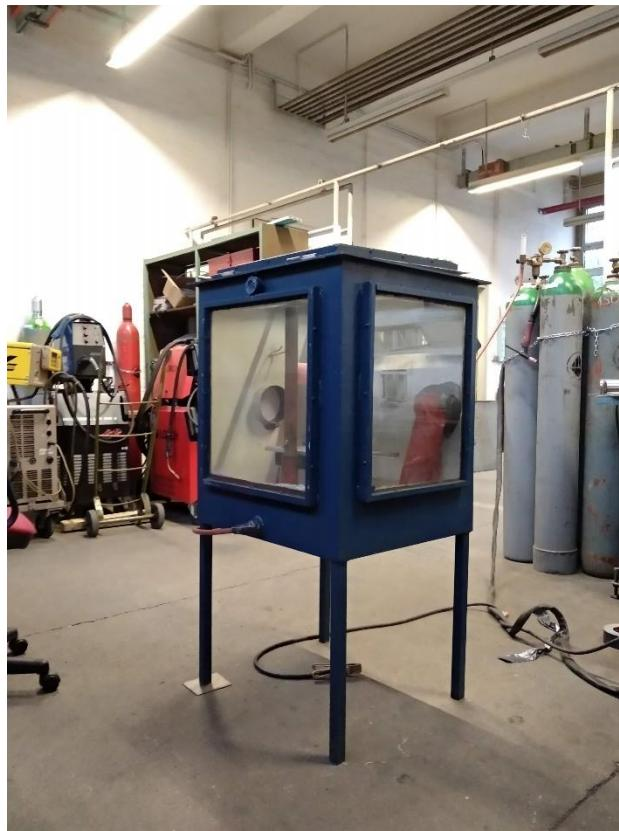
**Slika 26: Komora za zavarivanje**
