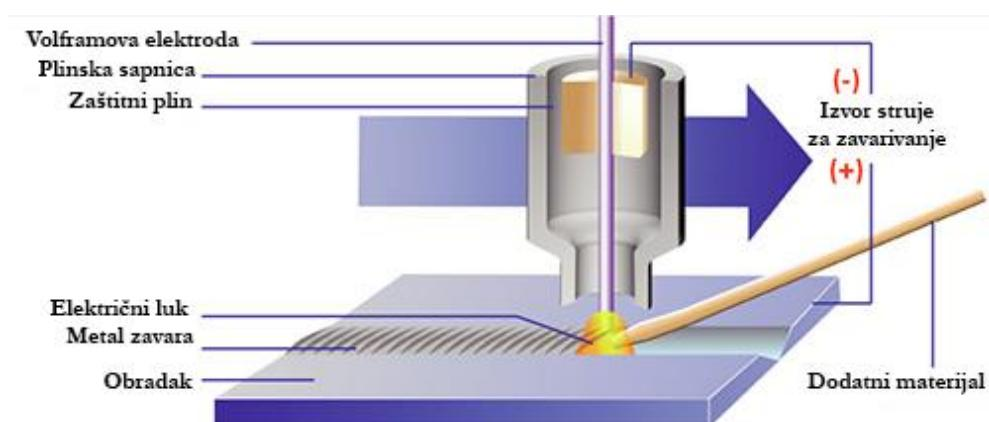
**Slika 16: Prikaz elektrolučnog zavarivanja metaljivom elektrodom u zaštiti inertnih plinova – TIG postupak zavarivanja [21]**
