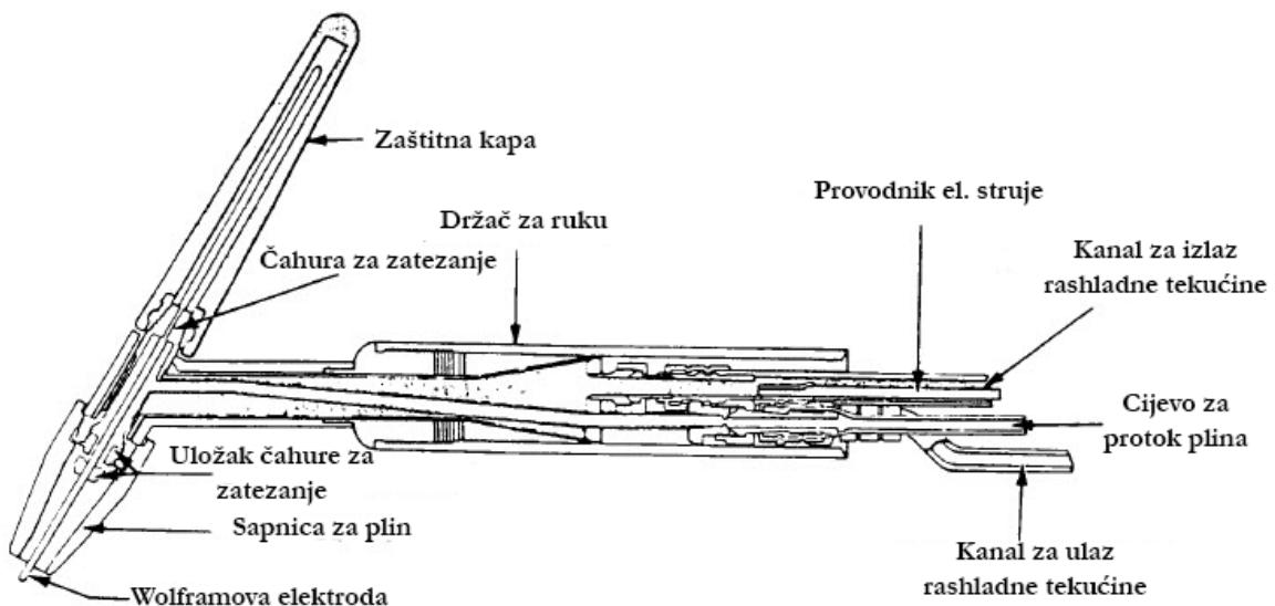
**Slika 18: Pištolj za TIG postupak zavarivanja hlađen rashladnom tekućinom [24]**
