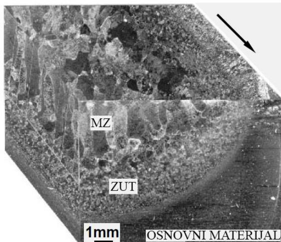
Slika 7: Kompozit mikrostrukture dijela zavarenog TIG postupkom [9]
