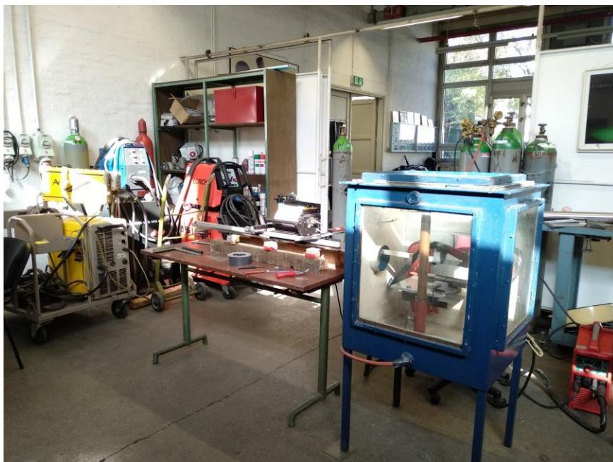
**Slika 28: Mehanizirani TIG postupak i korištena komora**
