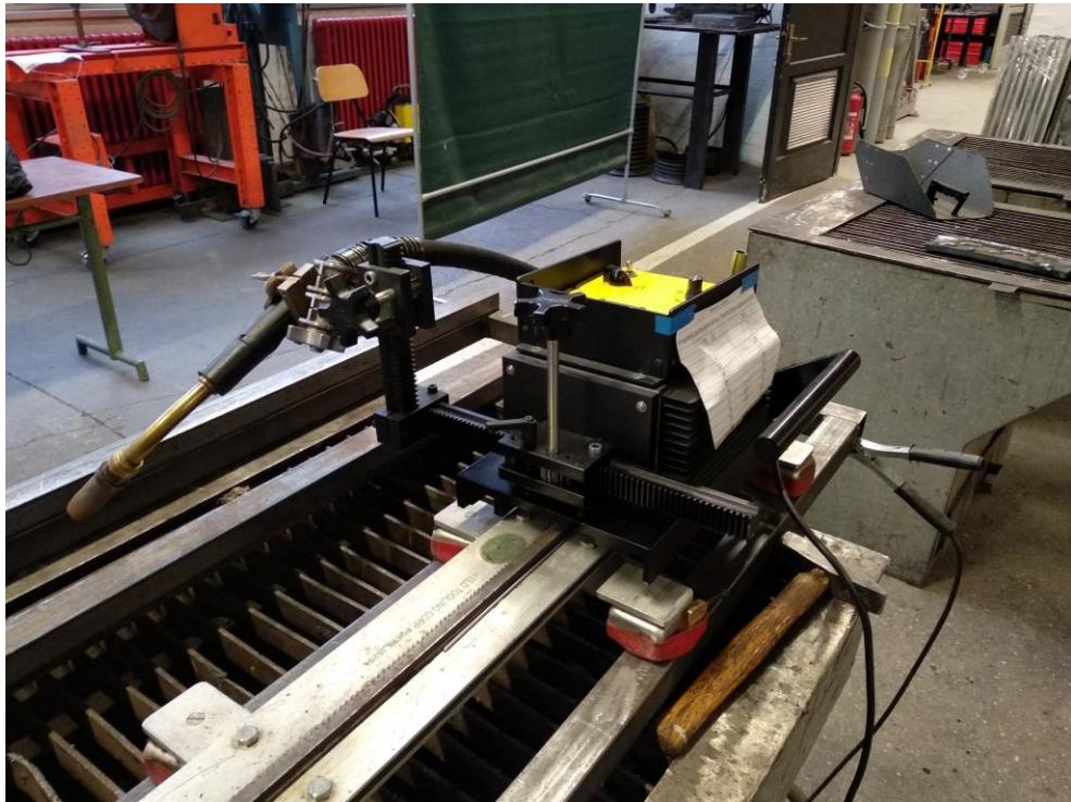
Slika 25: „BUGO Systems“ sustav za mehanizaciju postupka zavarivanja
