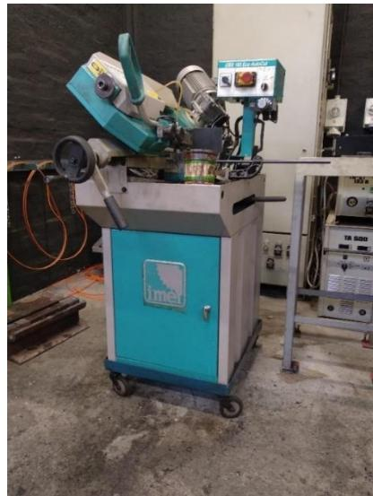
**Slika 30:** Tračna pila *IMET GBS 185 Eco AutoCut*
