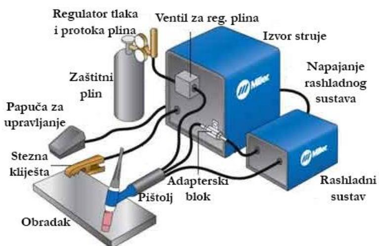
Slika 17: Komponente TIG sustava za zavarivanje [22]
