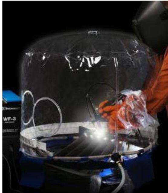
**Slika 22: Izvođenje postupka zavarivanja u komori za zavarivanje [29]**
