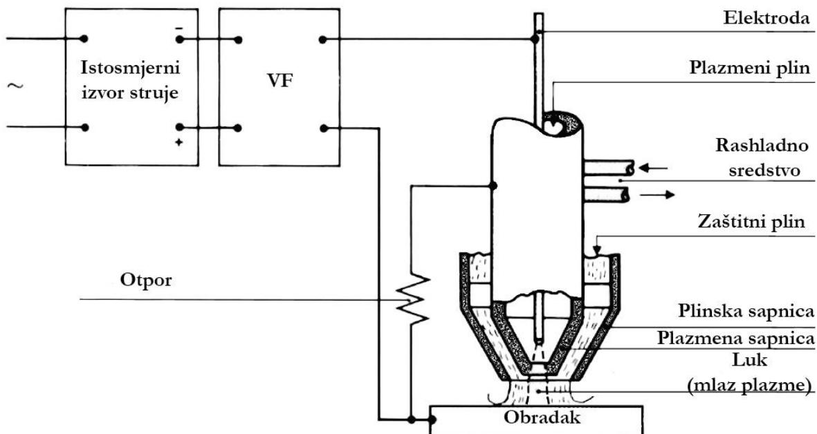
Slika 12: Shema sapnice i pištolja kod plazma zavarivanja [14]
