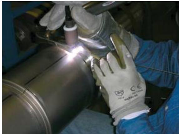
Slika 5: Primjena TIG postupka za zavarivanje cijevi izradene od titanija [8]
