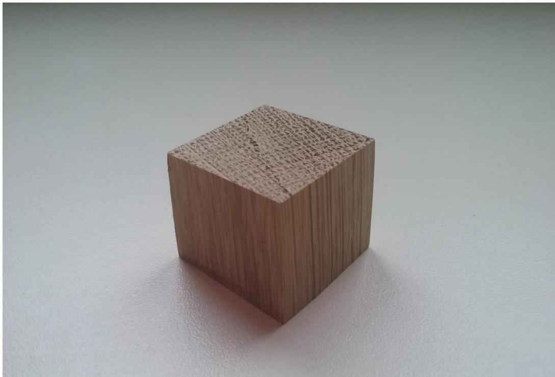
**Slika 25. Uzorak hrasta lužnjaka za ispitivanje gustoće**
