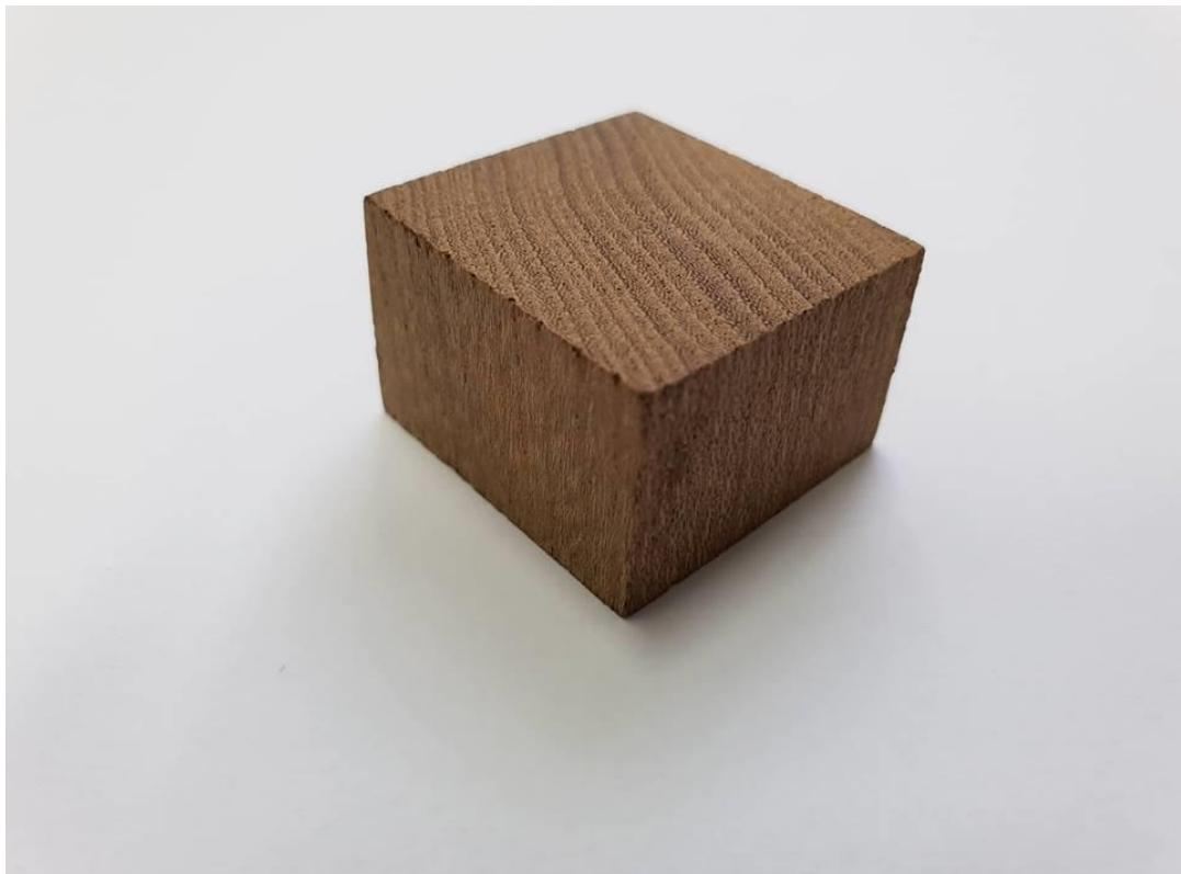
**Slika 24. Uzorak drva briješta za ispitivanje gustoće**
