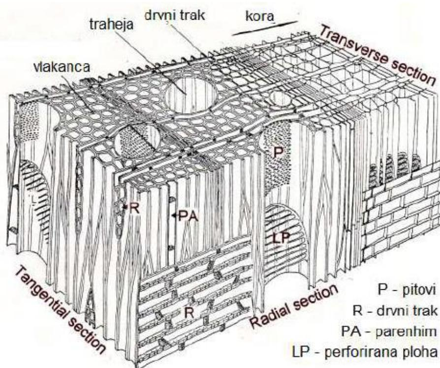
Slika 10. Mikrostruktura drva listača [8]
