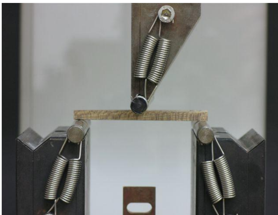
Slika 28. Ispitni uzorak na kidalici neposredno prije opterećivanja
