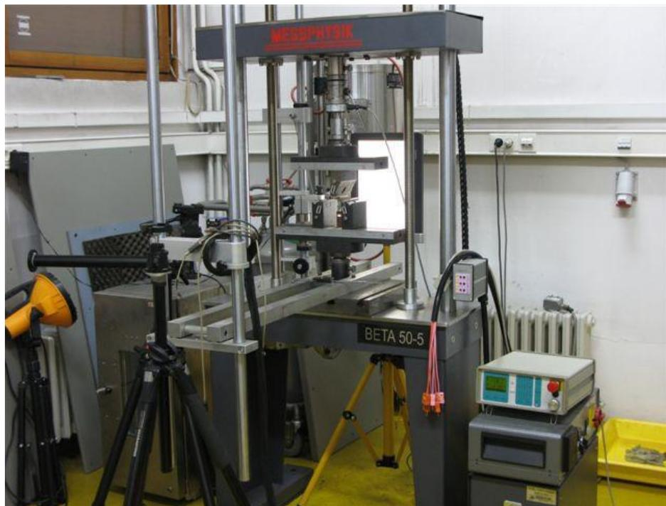
Slika 26. Kidalica MESSPHYSIK BETA 50-5 u labaratoriju za eksperimentalnu mehaniku
