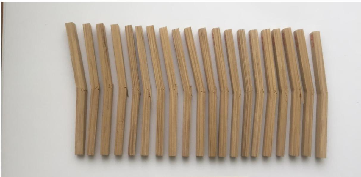
**Slika 31. Uzorci hrasta lužnjaka nakon ispitivanja na kidalici**
