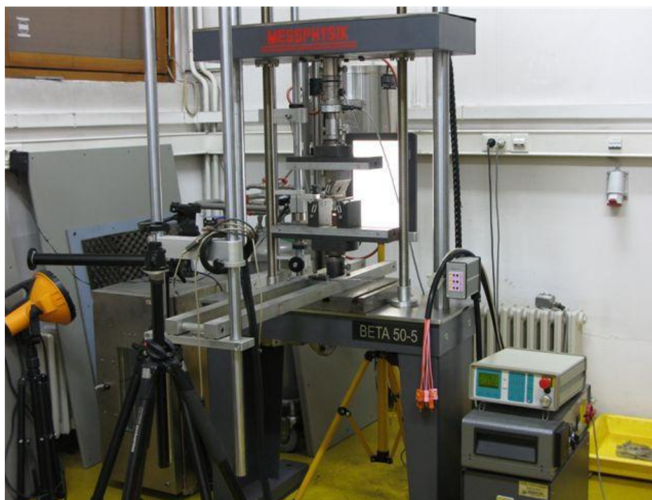
Slika 26. Kidalica MESSPHYSIK BETA 50-5 u laboratoriju za eksperimentalnu mehaniku
