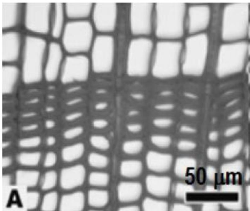
Slika 9. Poprečni presjek kroz drvo četinjače [2]
