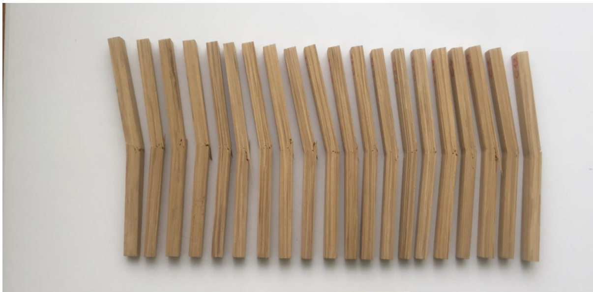
Slika 31. Uzorci hrasta lužnjaka nakon ispitivanja na kidalici
