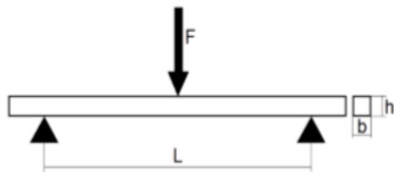
Slika 27. Metoda savijanja u tri točke [1]
