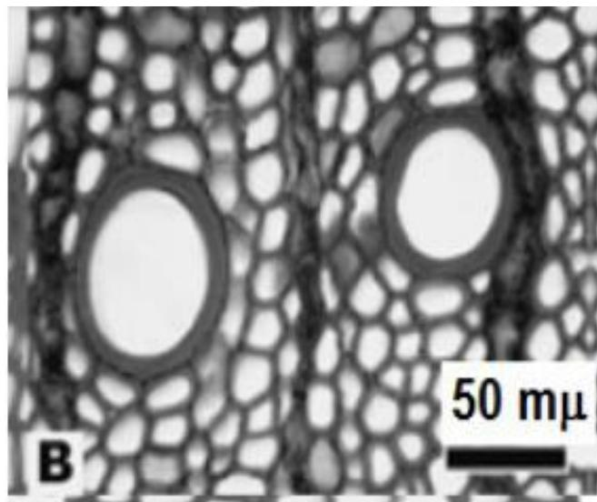
Slika 11. Poprečni presjek kroz drvo listače [2]
