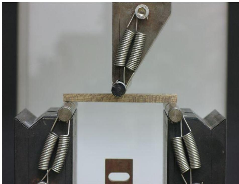
Slika 28. Ispitni uzorak na kidalici neposredno prije opterećivanja
