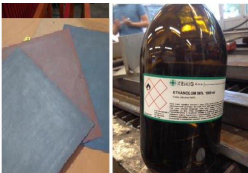
Slika 53. Sredstva za pripremu površine osnovnog materijala
