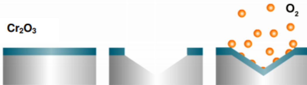
Slika 3. Mehanizam samoobnavljanja pasivnog filma [2]
