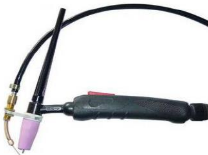
Slika 26. Pištolj za poluautomatizirano TIG zavarivanje [24]
