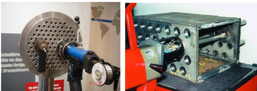
Slika 32. Primjer glave za zavarivanje u cijevnu stjenku [26]
