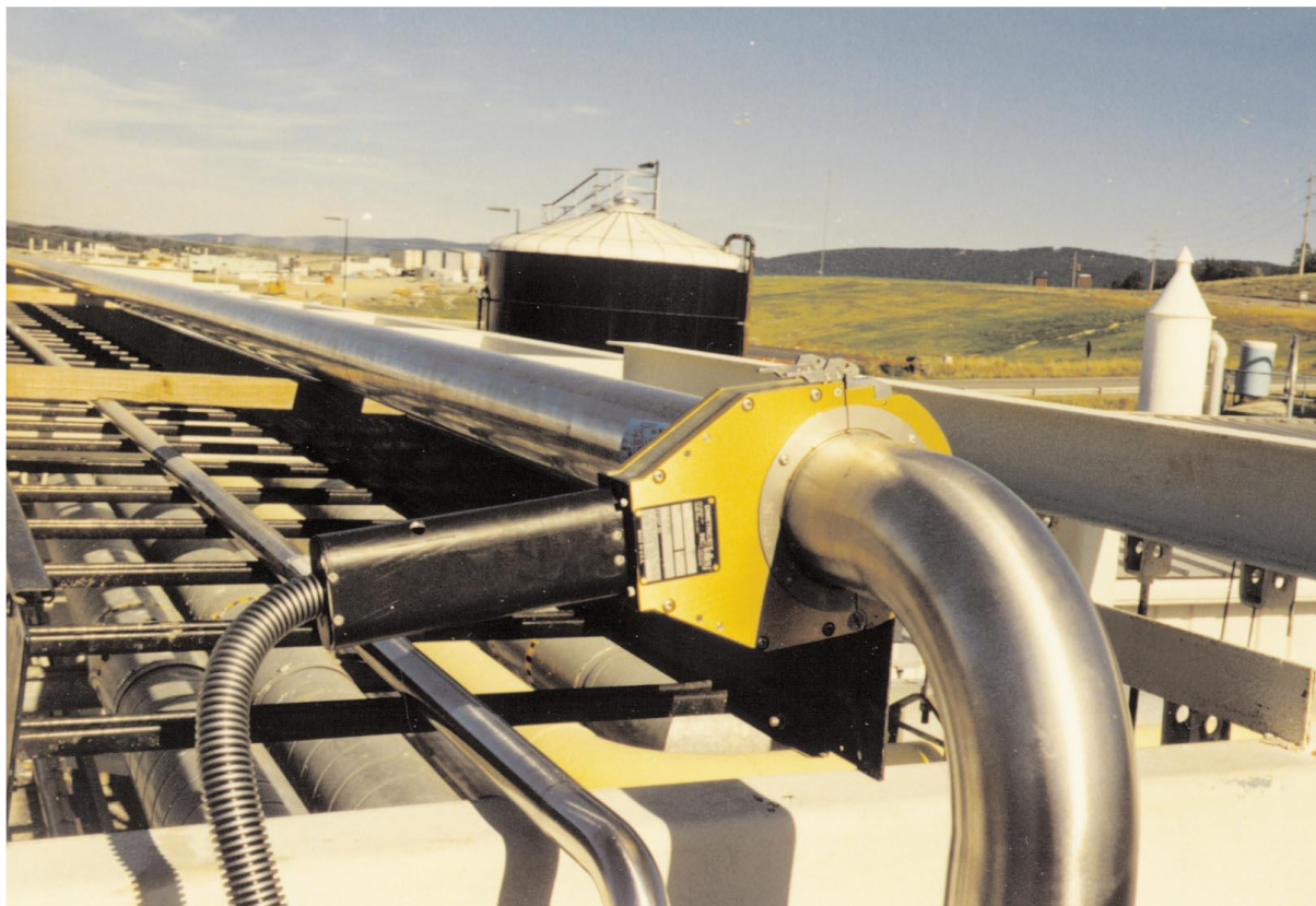
Slika 30. Primjer zatvorene glave za zavarivanje [42]
