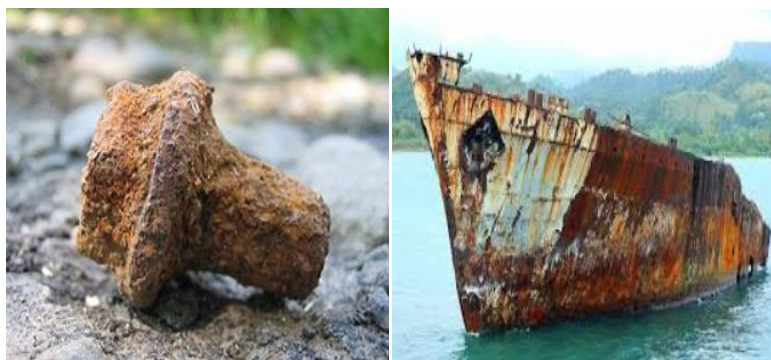
Slika 11. Primjeri opće korozije nelegiranih čelika [15]
