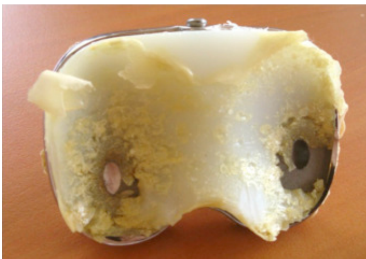
Slika 7. Potrošeni polietilenski dio implantata koljena [11]
