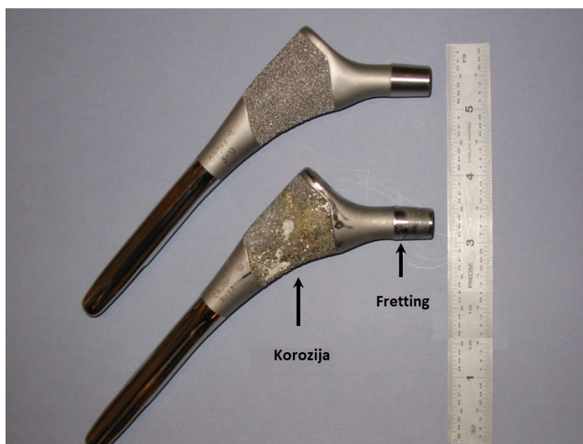
Slika 5. Korozija na femuralnom dijelu implantata kuka [8]
