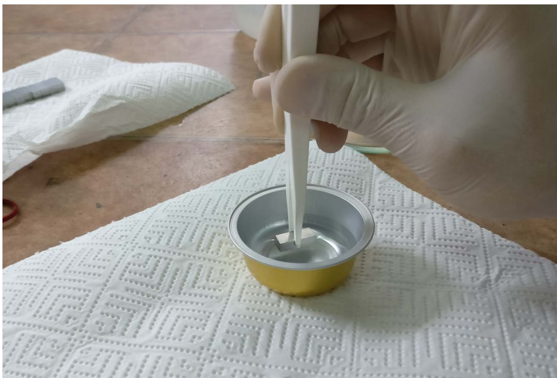
Slika 32. Kemijsko nagrizanje uzorka titanijeve legure
