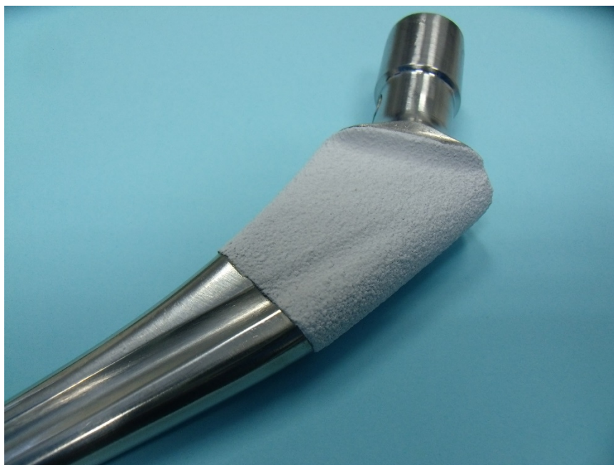
Slika 10. Prevlaka od hidroksiapatita na femuralnom dijelu implantatata zgloba kuka [23]
