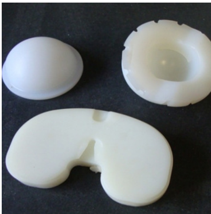
Slika 11. Dijelovi ortopedskih implantata od UHMWPE [24]
