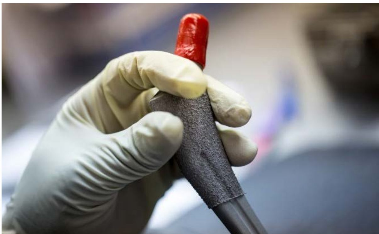
Slika 14. Sinterirana mrežica od tehnički čistog titanija na femuralnom dijelu proteze kuka [31]
