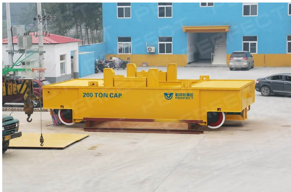
Slika 1.1: Kolica za transport tereta do 200 t u ljevaonici namjenjena za vožnju po tračnicama tvrtke HENAN PERFECT HANDLING EQUIPMENT [1]
