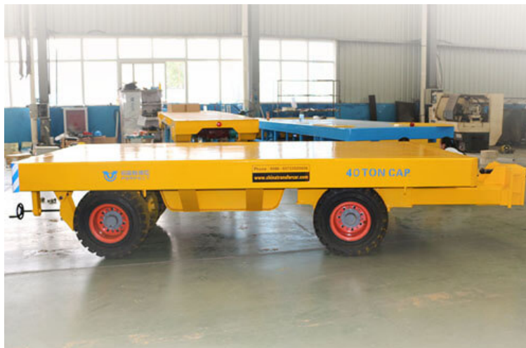
Slika 1.3: Kolica za transport 40t tereta prema [1]
