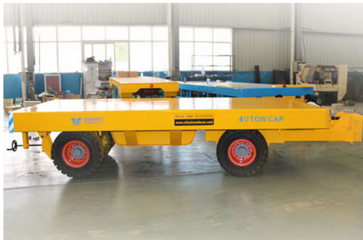
Slika 1.3: Kolica za transport 40t tereta prema [1]
