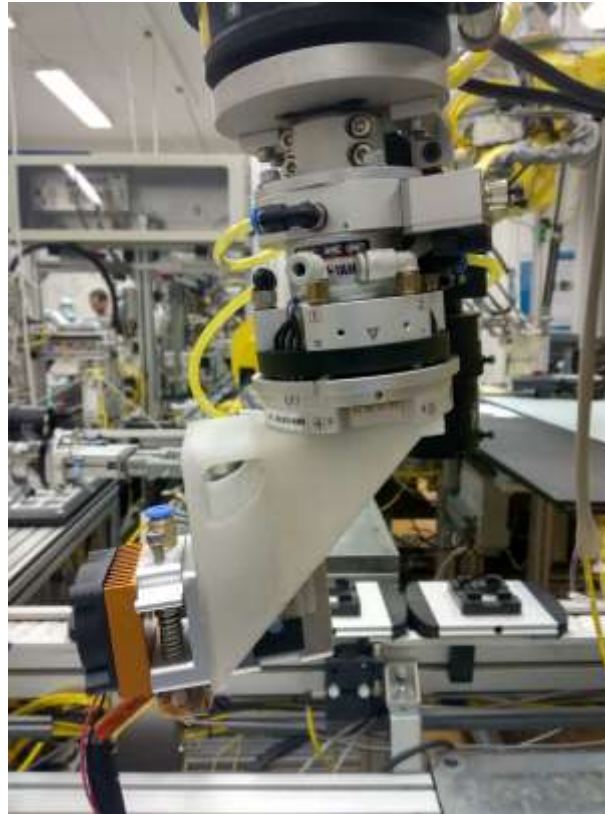
Slika 7. Ekstruder montiran na robotsku ruku
