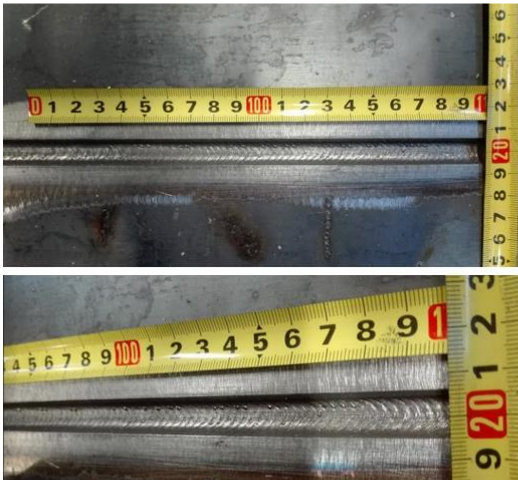
Slika 62. Izgled zavarenog spoja korijena
