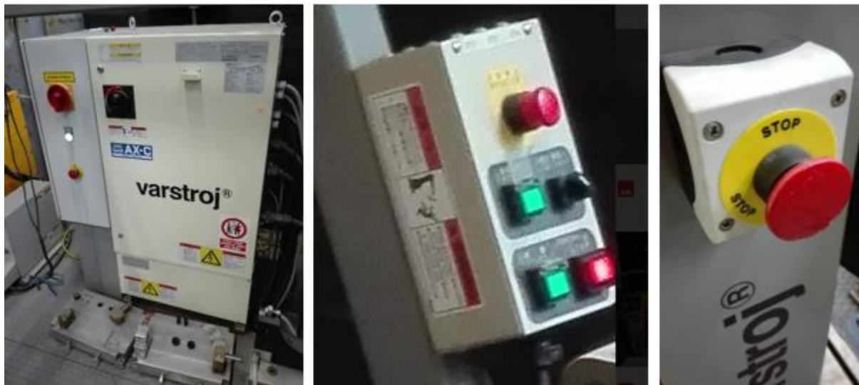
Slika 48. AX - C kontroler
