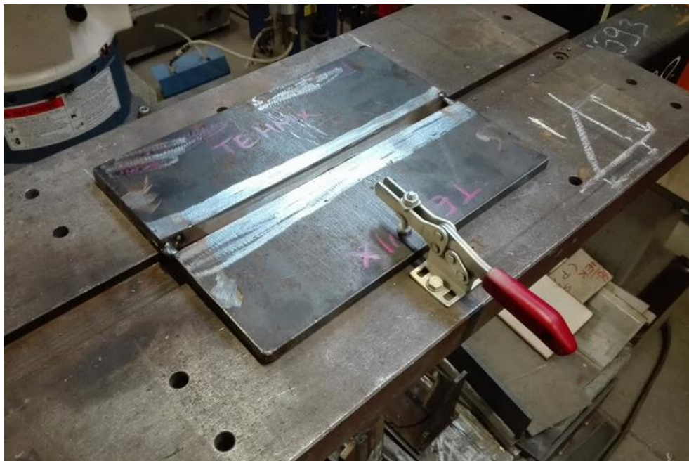
Slika 57. Stezanje uzorka pomoću stezne naprave za pozicioner
