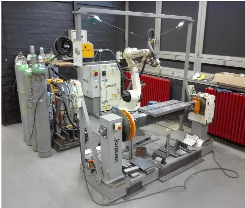
Slika 42. Robotska stanica u Laboratoriju za zavarivanje
