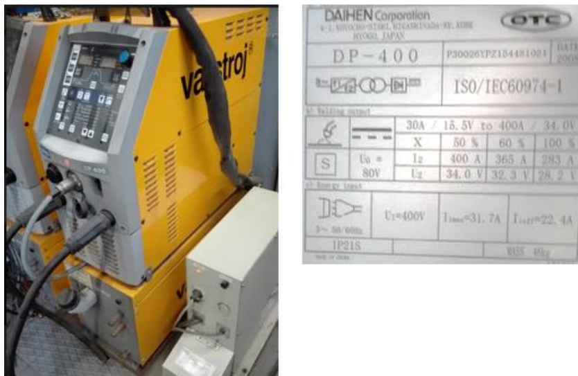
Slika 50. Izvor struje OTC Daihen 400 i njegove specifikacije
