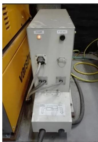
**Slika 52. Senzor električnog luka AX - AR**
