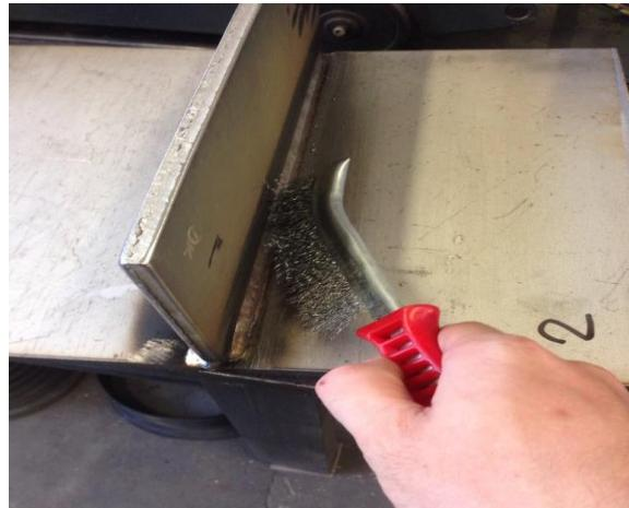
Slika 16. Čišćenje uzoraka četkom
