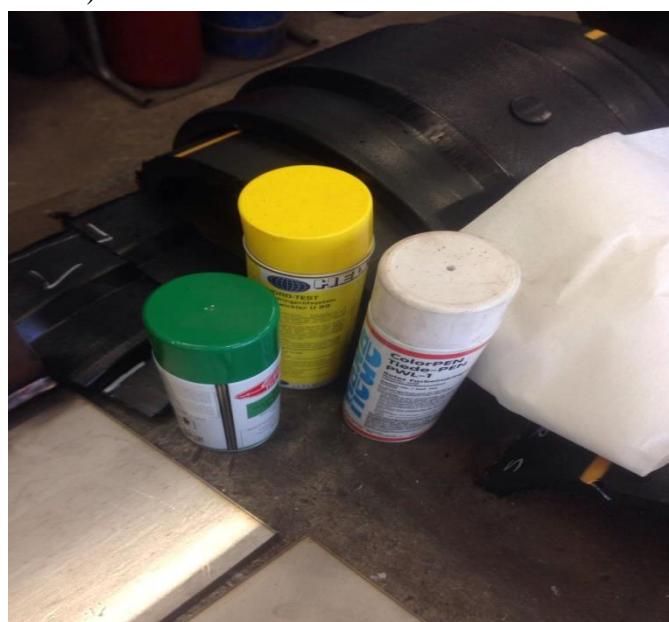
**Slika 19. čistač, penetrant i razvijač**
