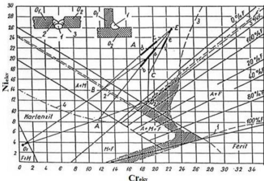
**Slika 7.: Prikaz primjene Schaeffler-ovog strukturalnog dijagrama pri prethodnom određivanju kemijske i strukturne heterogenosti slojeva zavara [10]**
