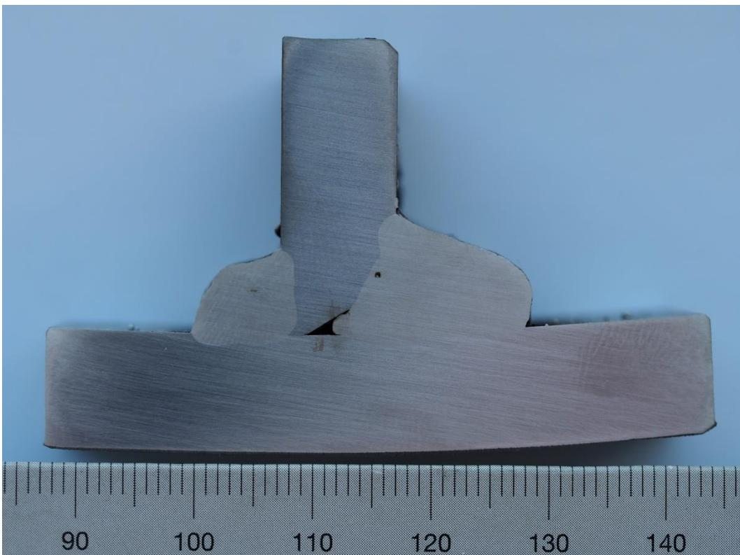
Slika 25. makro izbrusak presjeka zavarenog spoja, uzorak 2
