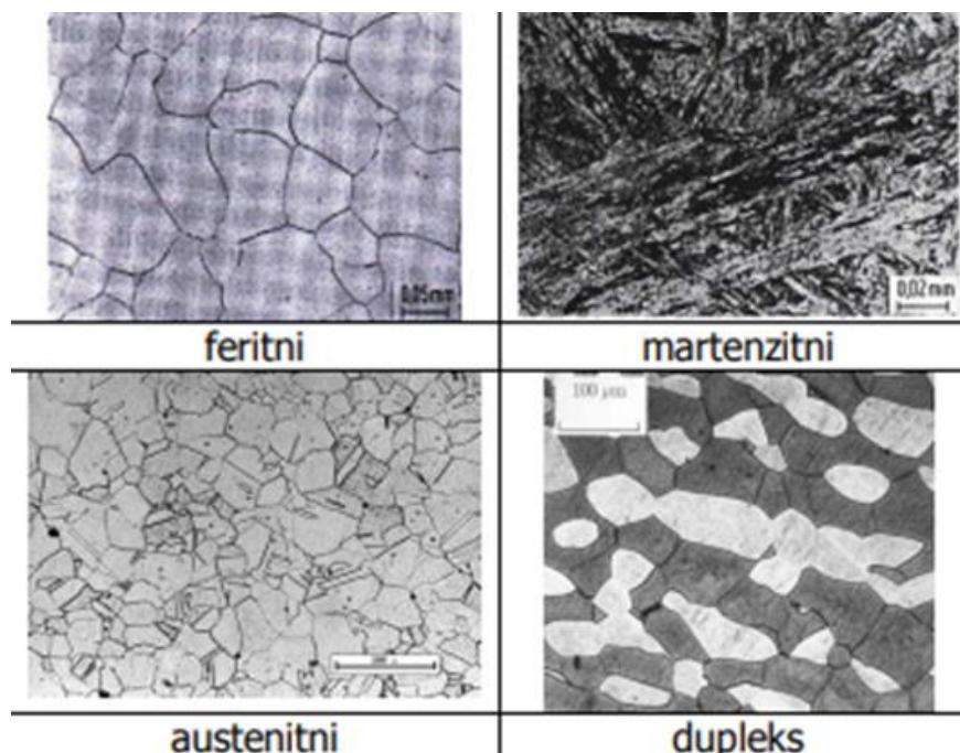
**Slika 2. Karakteristične mikrostrukture pojedinih grupa visokolegiranih čelika[4]**
