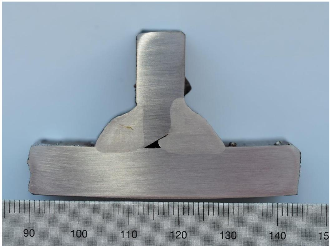
Slika 24. makro izbrusak presjeka zavarenog spoja, uzorak 1
