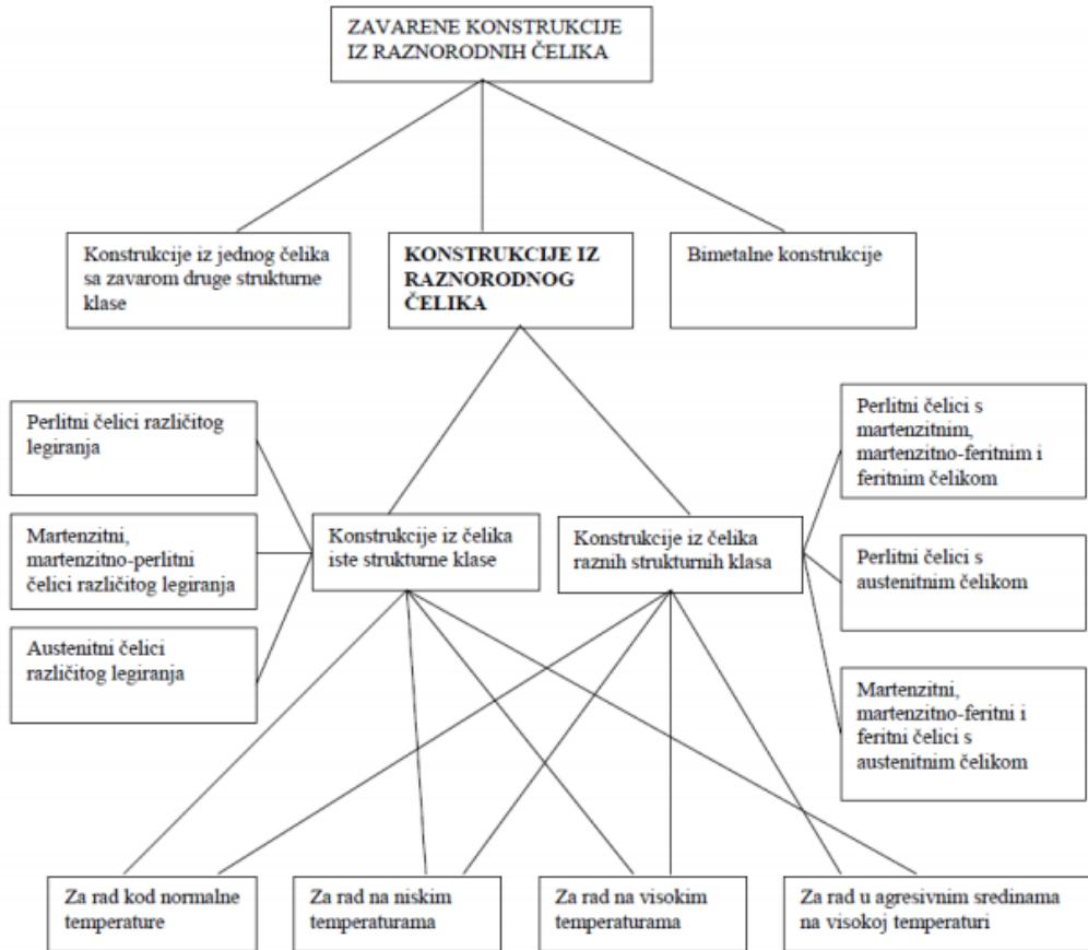
Slika 4. Podjela zavarenih konstrukcija od raznorodnih čelika [10]
