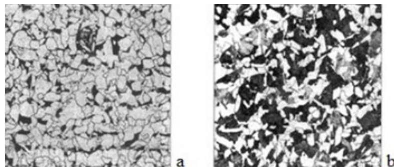
Slika 1. Feritno – perlita mikrostruktura nelegiranog konstrukcijskog čelika a) čelik s 0,1 %C; b) čelik s 0,25 %C [3]
