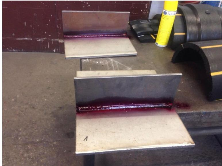
Slika 20. površine zavarenih spojeva s nanesenim penetrantom
