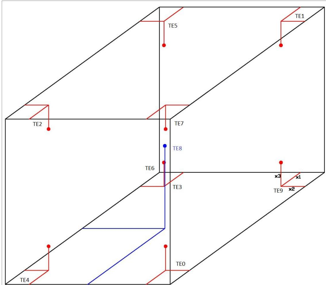
**Slika 12. Shema razmještaja termometara po radnom volumenu komore**
