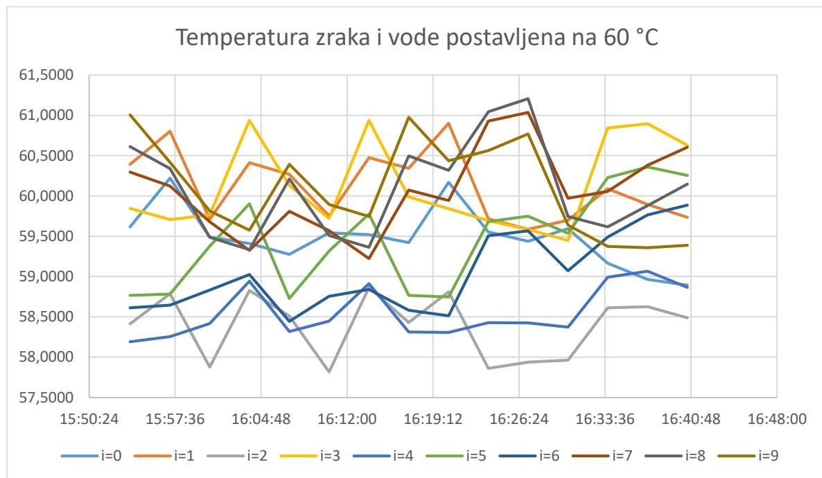
**Slika 23. Prikaz temperatura u komori tokom mjerjenja u svim mjernim točkama (T = 60 °C)**
