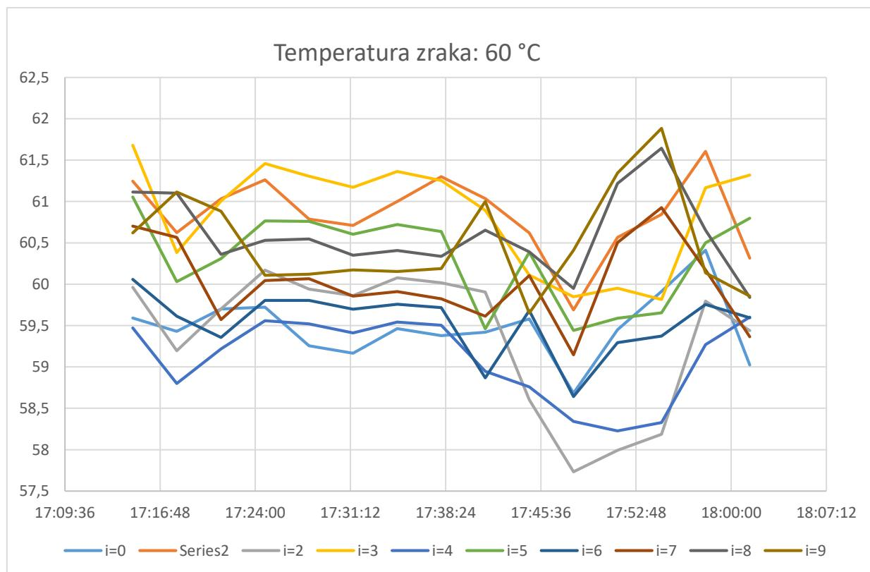
Slika 18. Prikaz temperatura u komori tokom mjerjenja u svim mjernim točkama ( $T = 60 ^\circ C$ )
