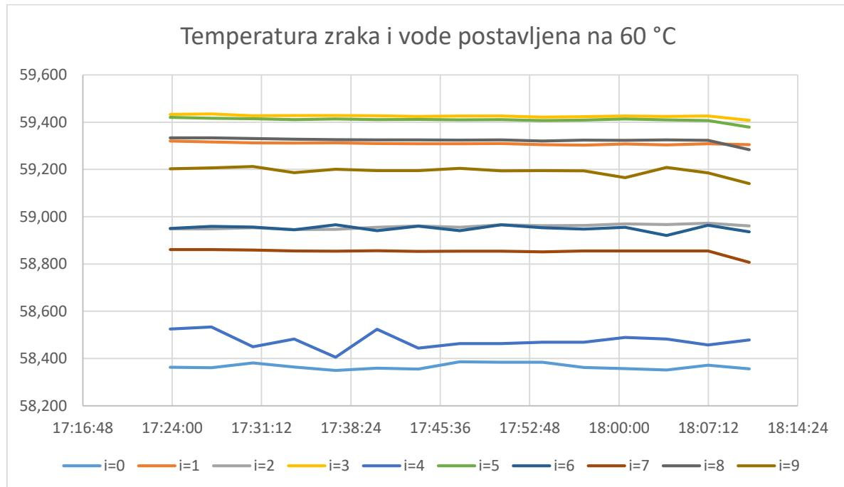
Slika 26. Prikaz temperatura u komori tokom mjerjenja u svim mjernim točkama (T = 60 °C)
