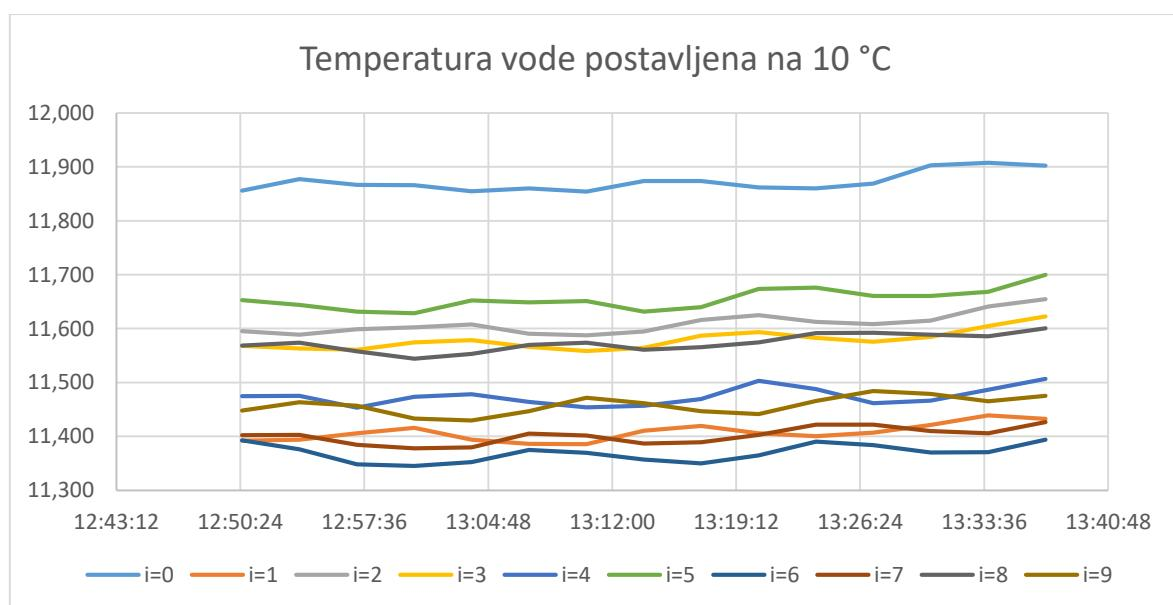
Slika 24. Prikaz temperatura u komori tokom mjerena u svim mjernim točkama ( $T = 10 °C$ )
