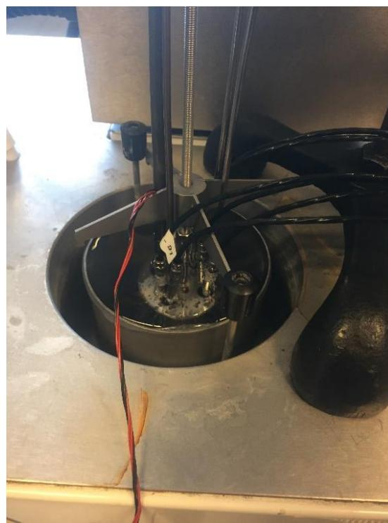
slika 8. Termometri uronjeni u izotermalni blok
