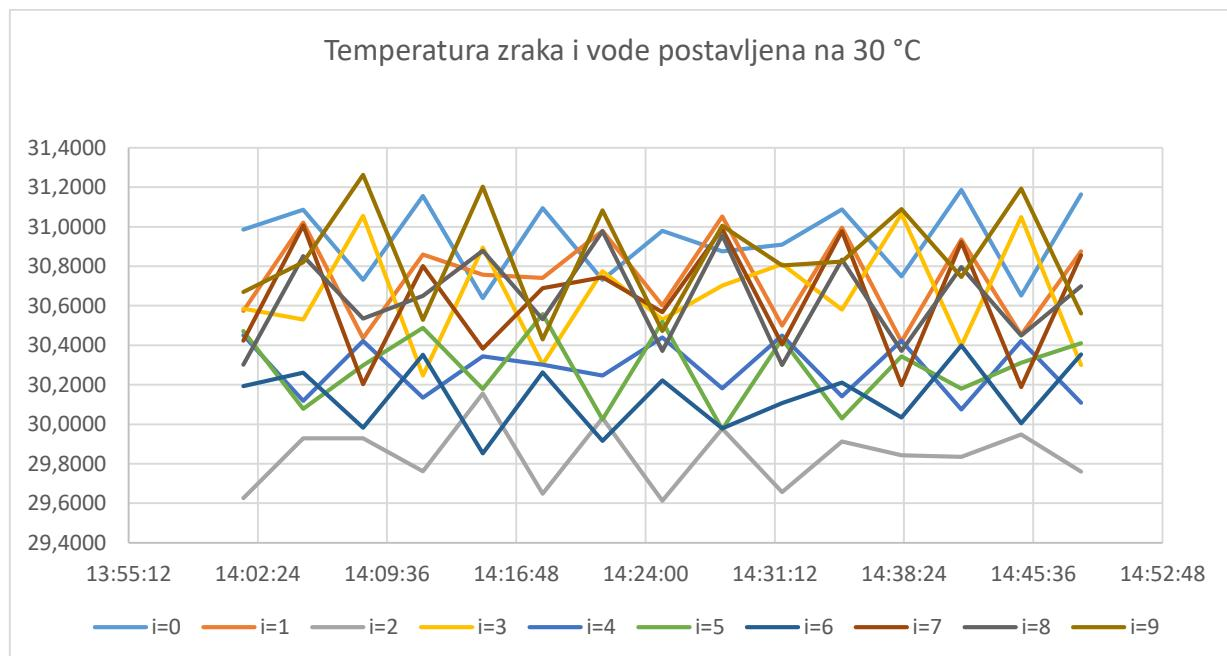
**Slika 22. Prikaz temperatura u komori tijekom mjerjenja u svim mjernim točkama (T = 30 °C)**
