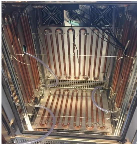
**Slika 13. Prikaz razmještaja termometara po radnom volumenu komore**
