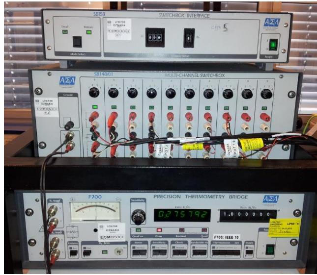
**Slika 5. Termometrijski otpornički most (spojene sve navedene komponente)**
