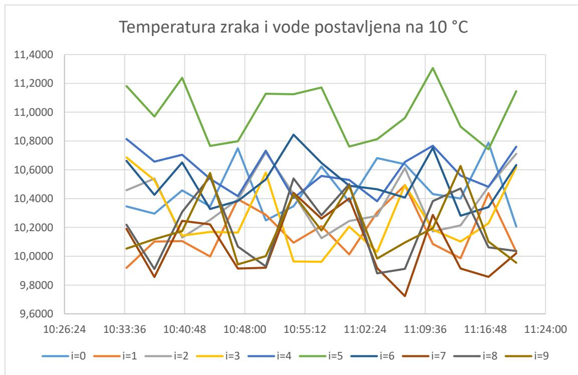
**Slika 21. Prikaz temperatura u komori tijekom mjerjenja u svim mjernim točkama (T = 10 °C)**
