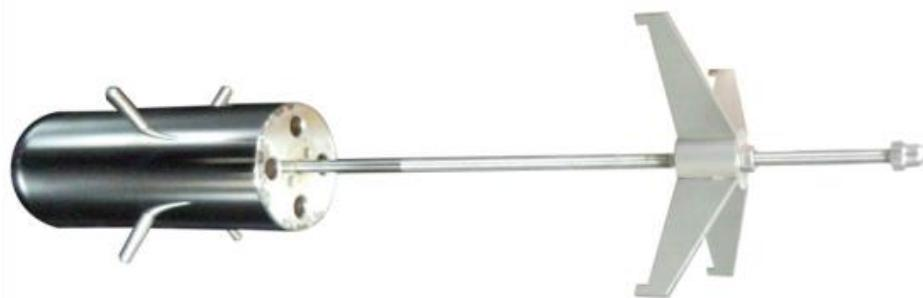
Slika 7. Izotermalni blok za termostatirane kupke
