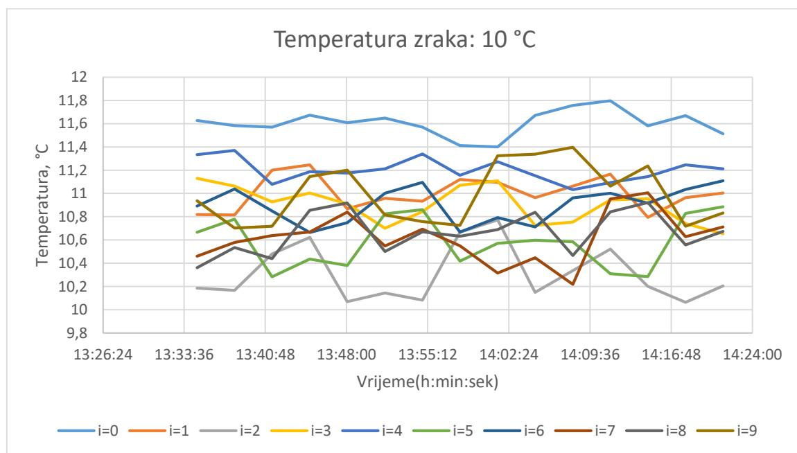
Slika 16. Prikaz temperatura u komori tokom mjerena u svim mjernim točkama ( $T = 10$  °C)
