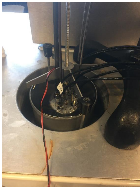
slika 8. Termometri uronjeni u izotermalni blok
