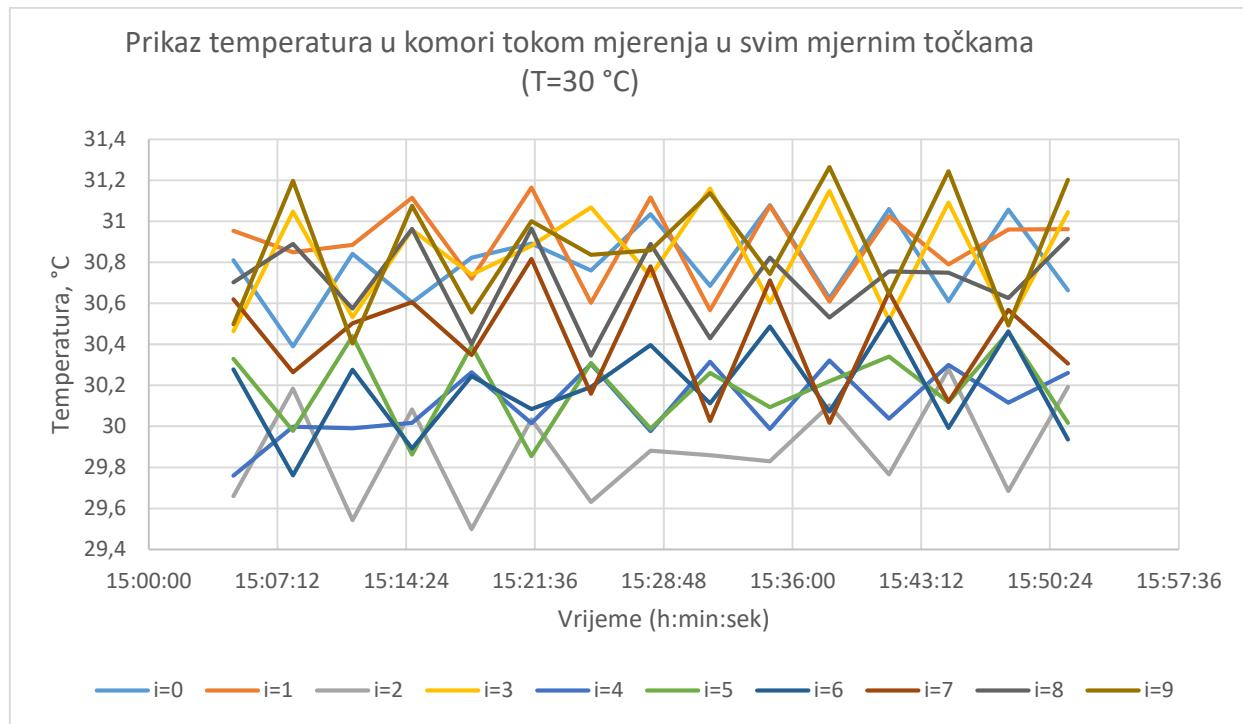
**Slika 17. Prikaz temperatura u komori tijekom mjerjenja u svim mjernim točkama (T = 30 °C)**
