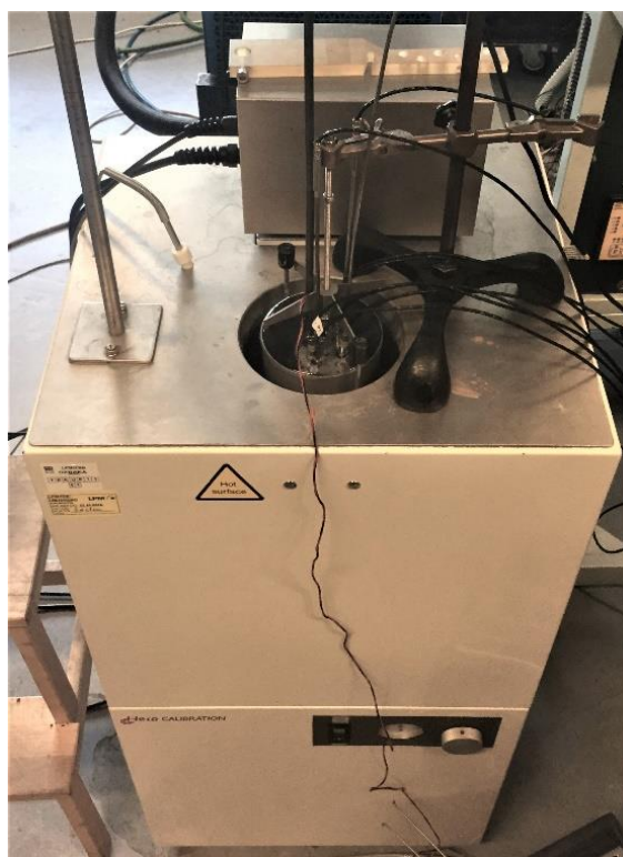
slika 9. Prikaz kupke, izotermalnog bloka i uronjenih termometara
