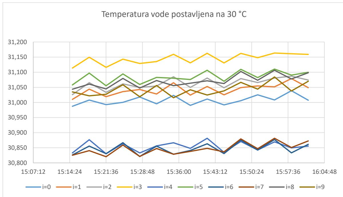
**Slika 25. Prikaz temperatura u komori tokom mjerjenja u svim mjernim točkama (T = 30 °C)**
