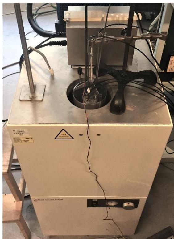
slika 9. Prikaz kupke, izotermalnog bloka i uronjenih termometara
