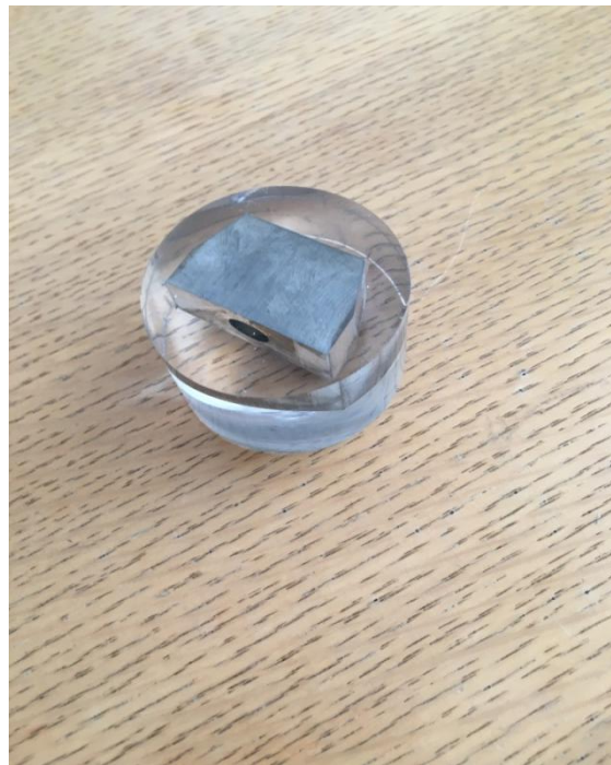
Slika 22. Uzorak zaliven u polimernoj masi
