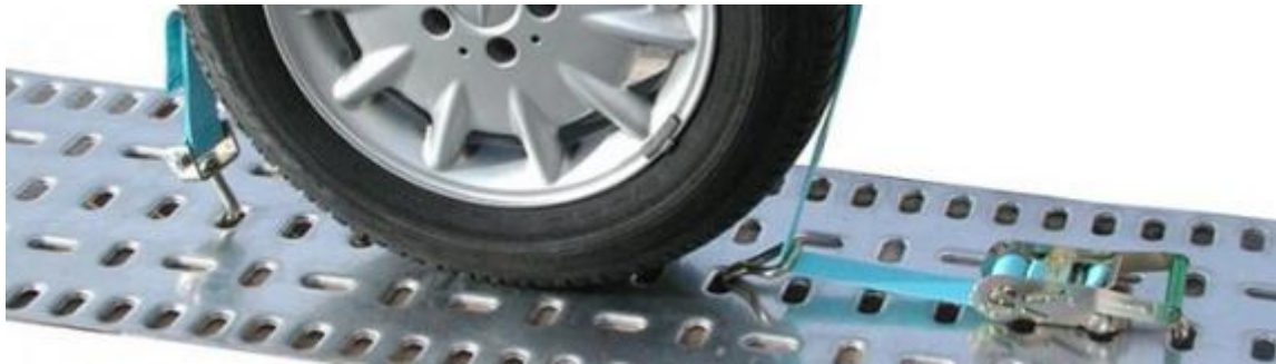
Slika 2. Način vezanja pomoću sigurnosnih traka [2]
