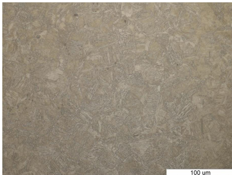
Slika 27. Mikrostruktura jezgre pod povećanjem od 500x
