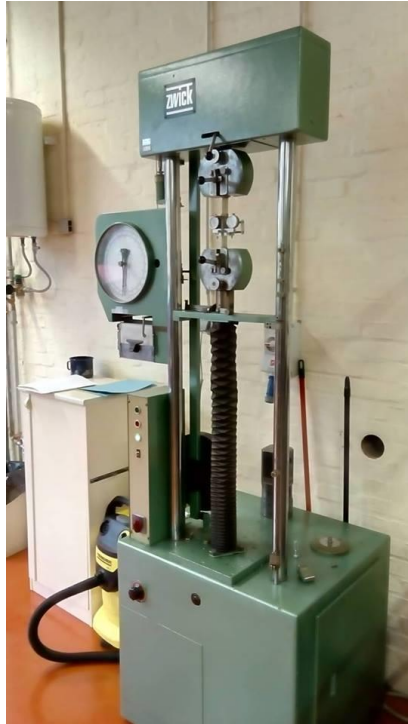
Slika 3.10. Kidalica proizvođača VEB Thüringer Industriewerk, Rauenstein, Njemačka; razredom točnosti 1,0 u mjernom području 0-4800 N
