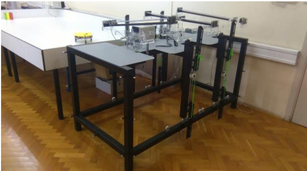
Slika 1.1. Laboratorijski postav elastično povezanih njihala u laboratoriju Katedre za strojarsku automatiku na Fakultetu strojarstva i brodogradnje
