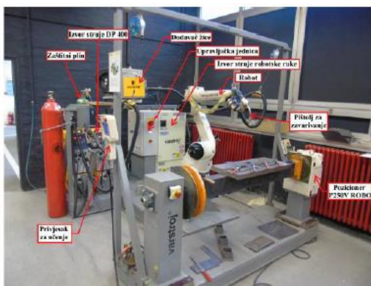
Slika 23. Robotska stanica Almega OTC AX V6 [6]
