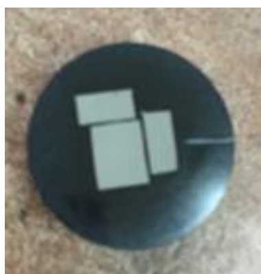
Slika 38. Izgled uzorka prije nagrivanja površine
