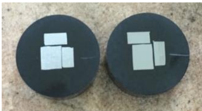
Slika 40. Nagriveni i nenagriveni uzorak
