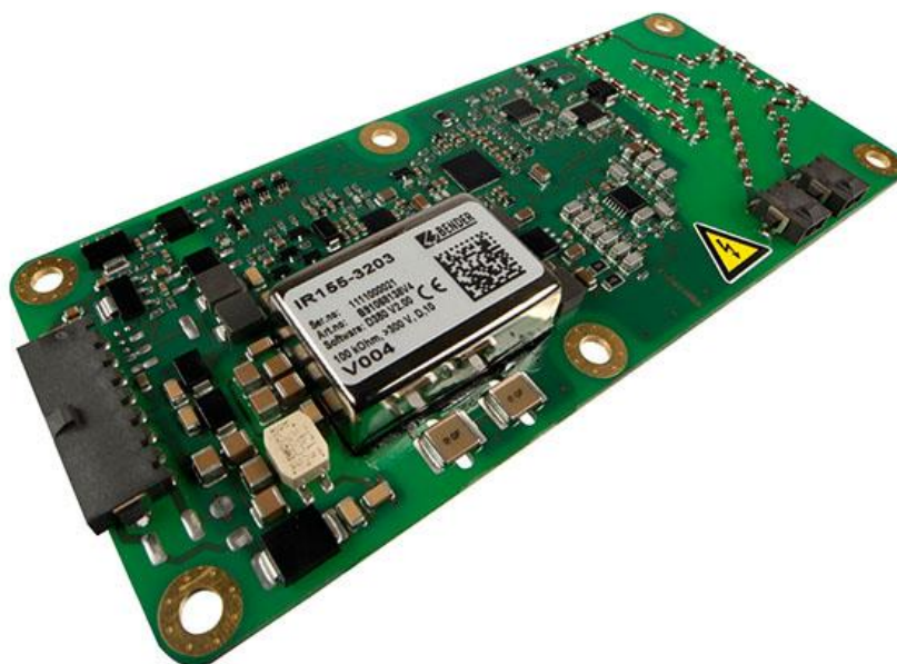
Slika 11. Uređaj za nadzor izolacije [10]
