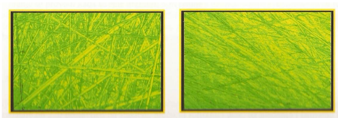
Slika 13: Izgled površine ispravno i neispravno brušenog uzorka
