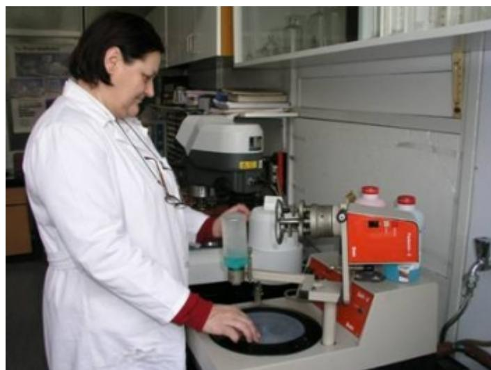
Slika 15: Brušenje referentne etalonske pločice tvrdoće
