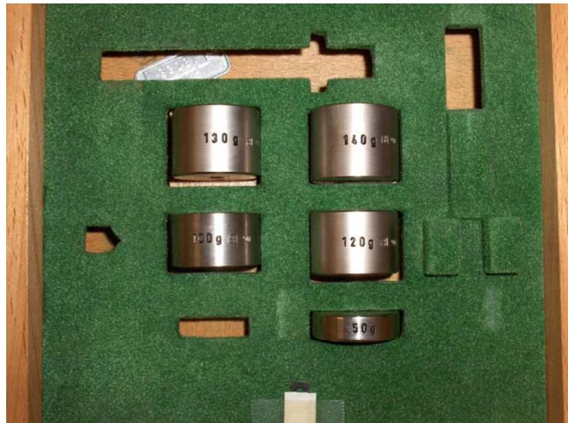
Slika 25: Utezi za mjerjenje mikrotvrdoće
