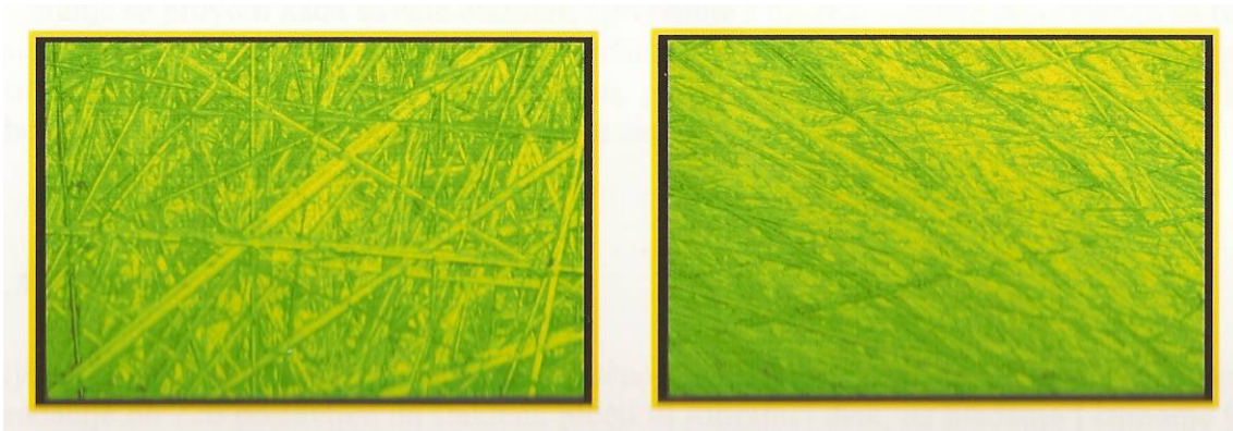
Slika 13: Izgled površine ispravno i neispravno brušenog uzorka
