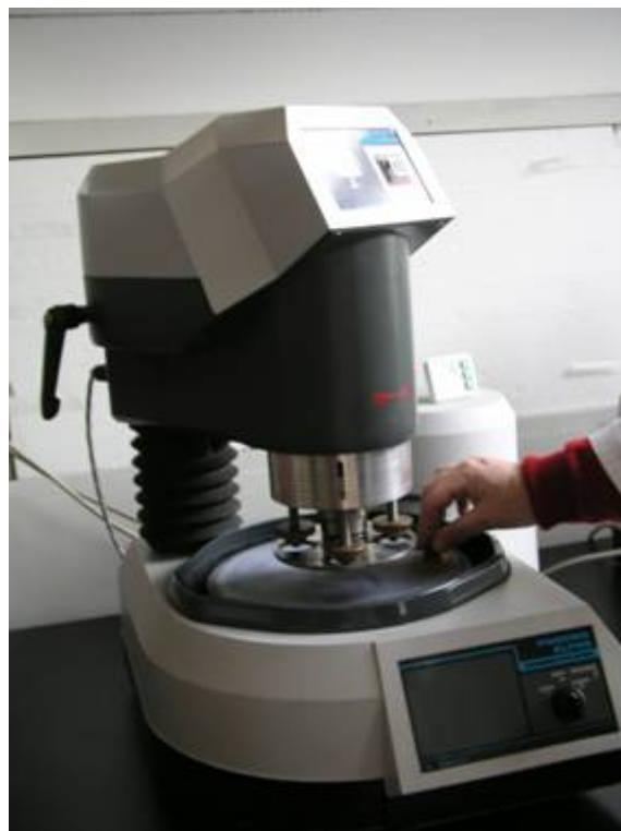
Slika 19: Poliranje referentne etalonske pločice
