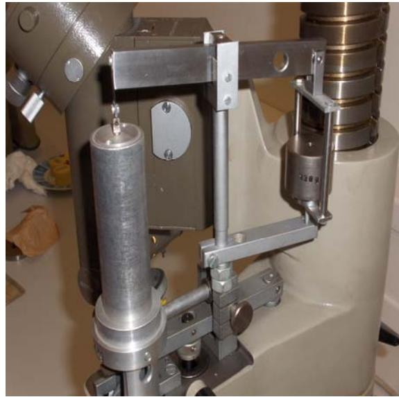
Slika 24: Polužni sustav za mjerjenje mikrotvrdoće
