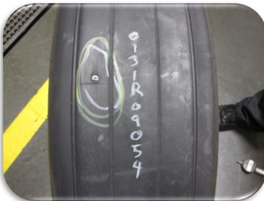
Slika 6. Vijak zaboden u gumu prilikom taksiranja [11]
