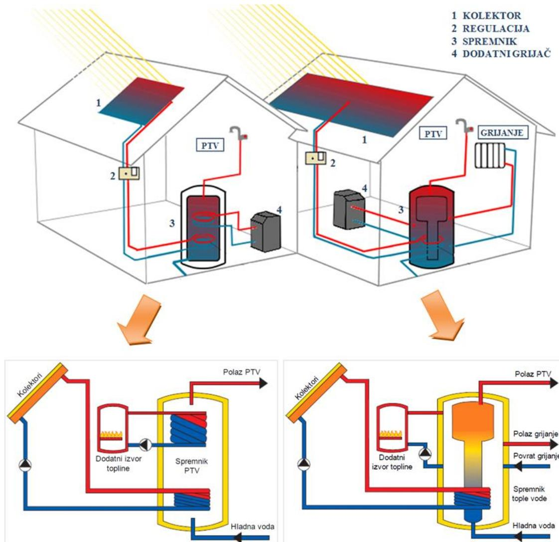
Slika 6 Solarni toplovodni sustav za pripremu PTV-a u usporedbi sa sustavom za pripremu PTV-a i grijanje prostora [1]
