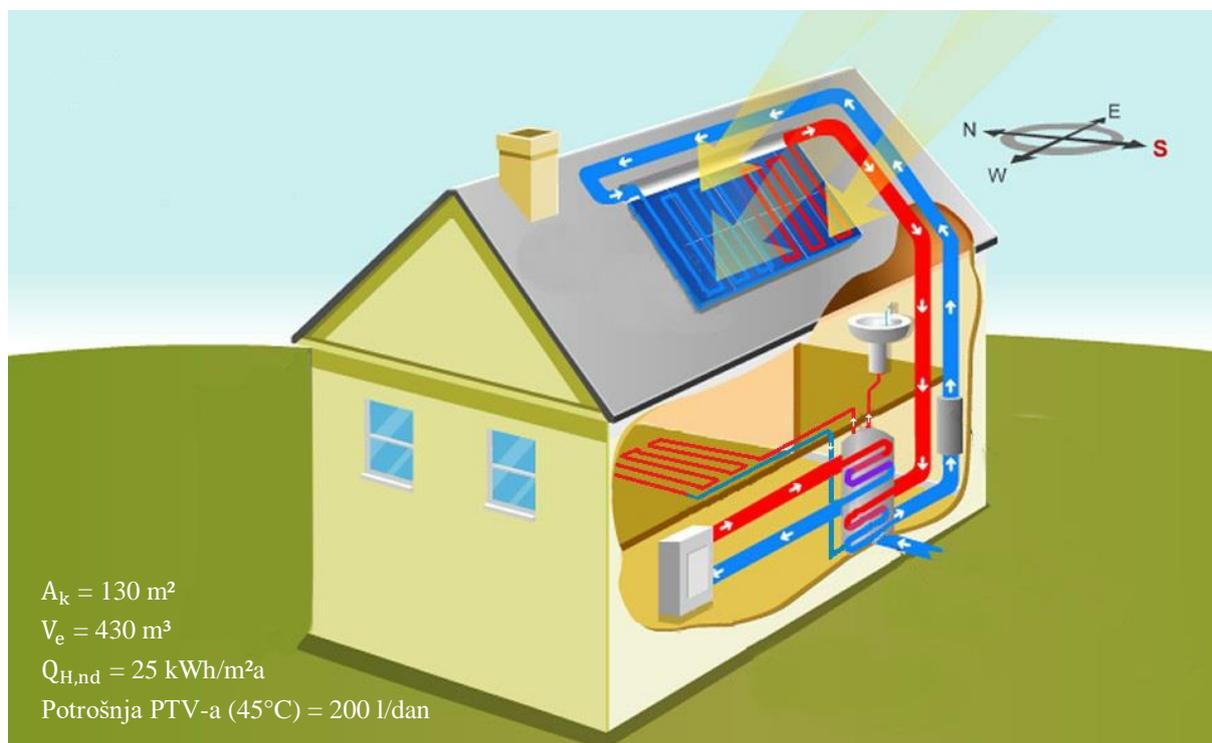
Slika 17 Razmatrana kuća s toplovodnim solarnim sustavom
