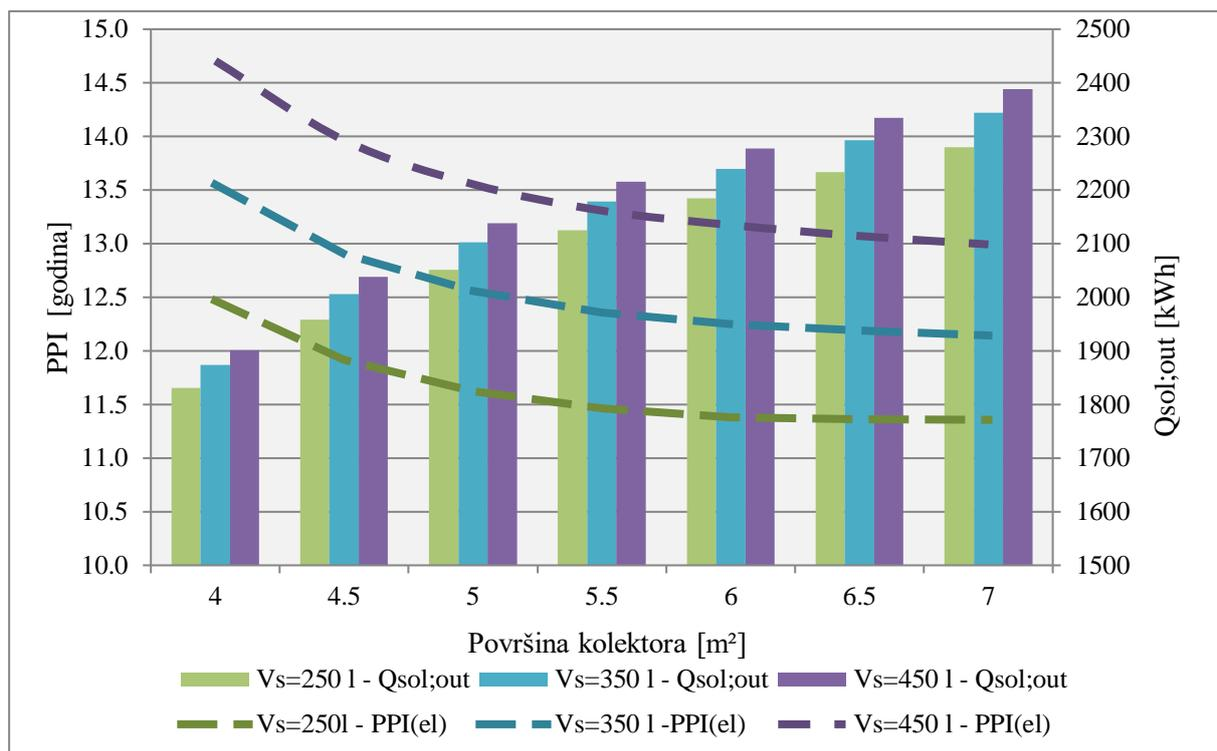
**Dijagram 18 Promjena perioda povrata investicije i iznosa isporučene toplinske energije u ovisnosti o površini kolektora i volumenu spremnika, mjesečna metoda, Zagreb**
