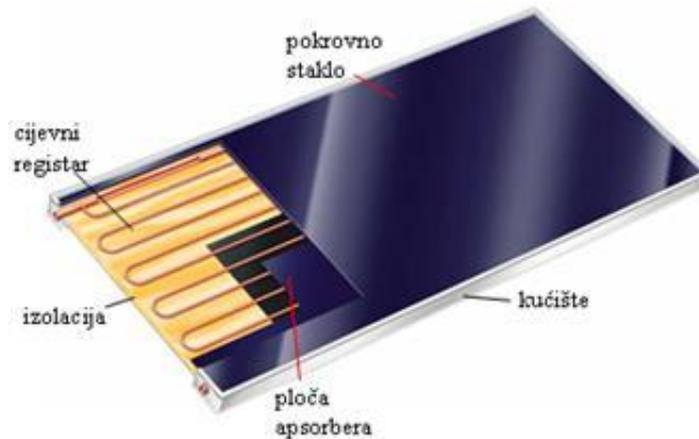
**Slika 5 Osnovni dijelovi pločastog kolektora[9]**
