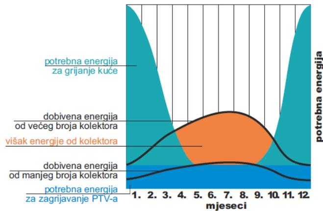
Slika 5 Općeniti prikaz raspodjele potreba za toplinskom energijom i dobivene energije kolektorima [7]
