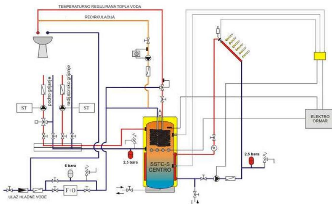
Slika 3 Sustav s protočnim izmjenjivačem PTV-a [2]
