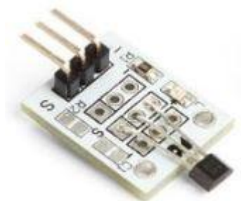
Slika 4. Hallov magnetski senzor [3]
