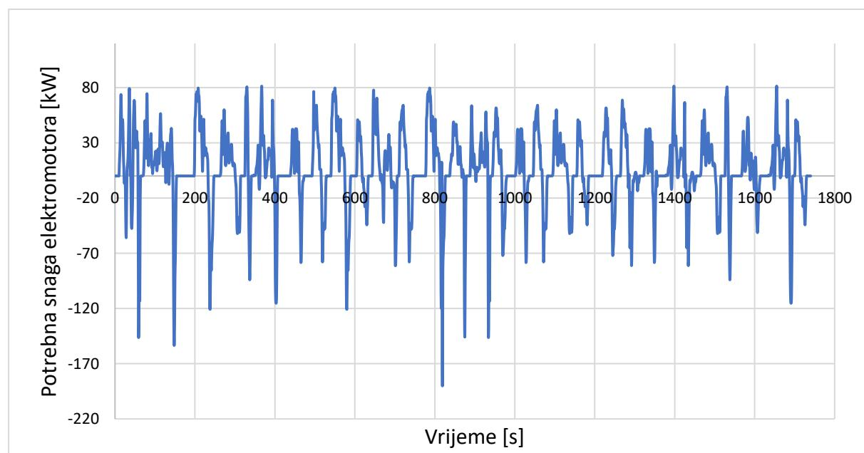
**Slika 20.** Dijagram potrebe snage elektromotora u ovisnosti o vremenu
