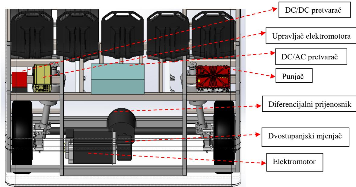
**Slika 31. Razmještaj glavnih komponenti električnog pogonskog sustava**
