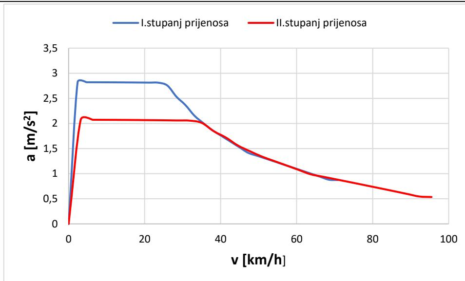
**Slika 35. Dijagram ubrzanja u ovisnosti o stupnju prijenosa**
