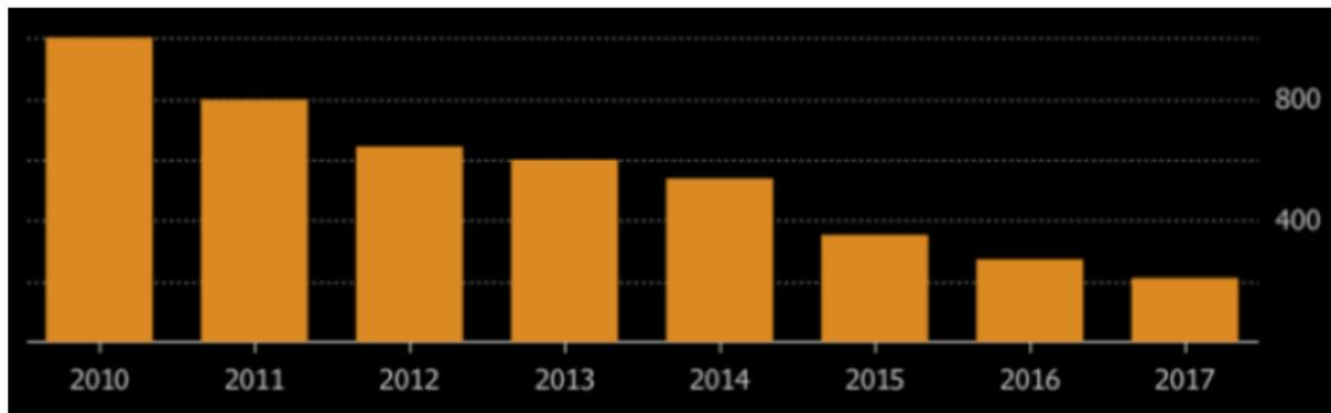
**Slika 37. Pad cijene 1 kWh litij-ionske baterije od 2010. godine**
