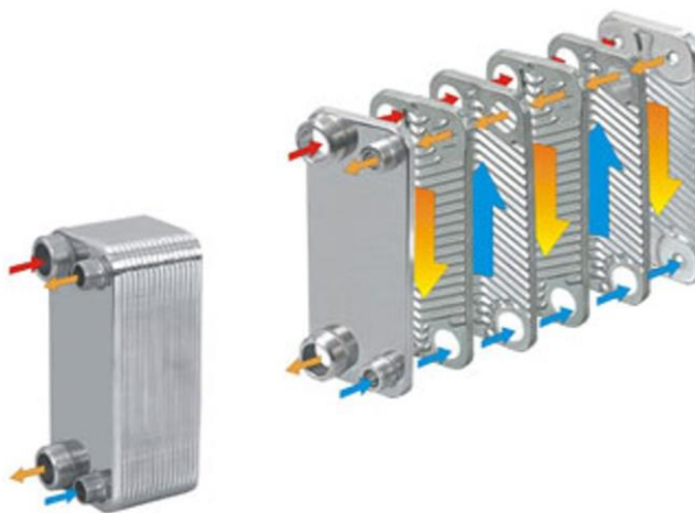
Slika 10, Pločasti izmjenjivač topline, [6]
