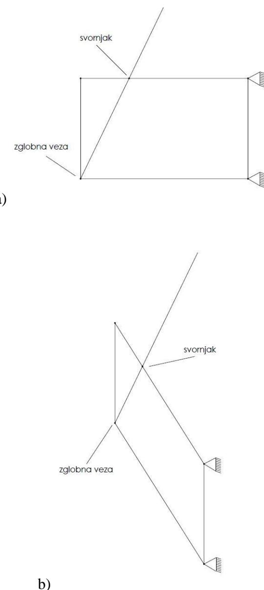
**Slika 9. Učvršćeni zglobni četverokut: a) spušteni položaj, b) podignuti položaj**
