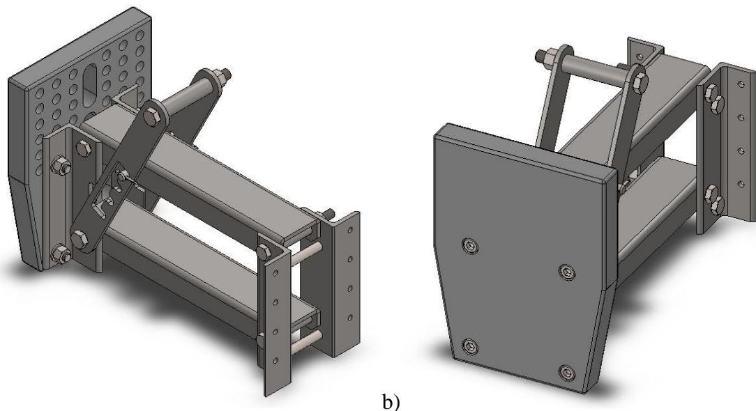
Slika 26. Konstrukcija s nosećom pločom: a) u izometriji, b) pogled na vanjsku stranu ploče
