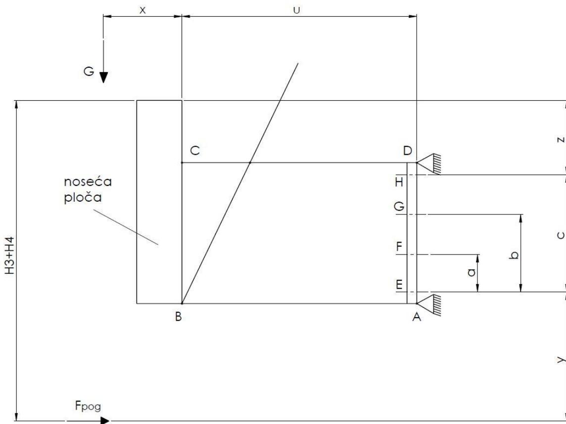
Slika 32. Pojednostavljeni prikaz djelovanja aktivnih sila na nosač
