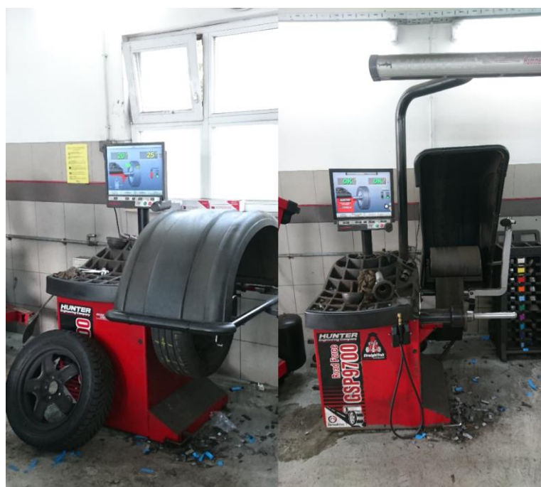
Slika 5. Stroj za ujednačavanje raspodjele mase na kotaču “Hunter GSP9700“
