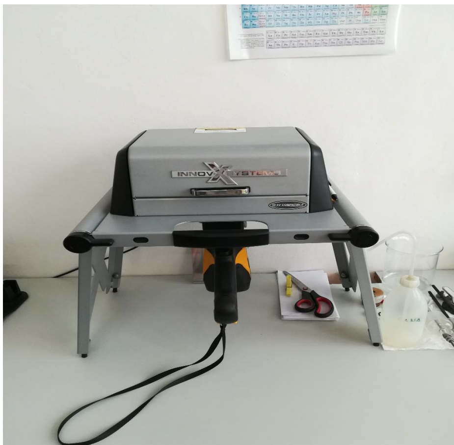
Slika 21. OLYMPUS XRF uređaj
