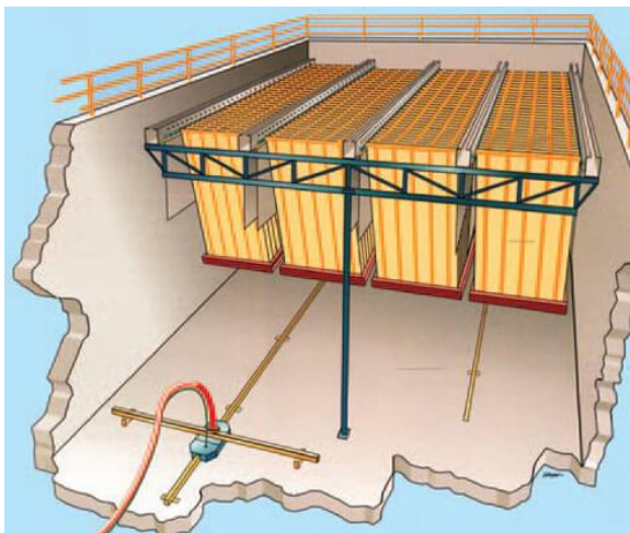
Slika 21. Montažna skica Ovivo FlexKlear taložnika
