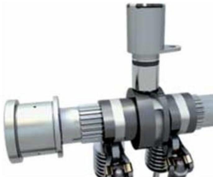
**Slika 5. Trostupanjski sustav s pomičnim brijegom bregastog vratila [3]**
