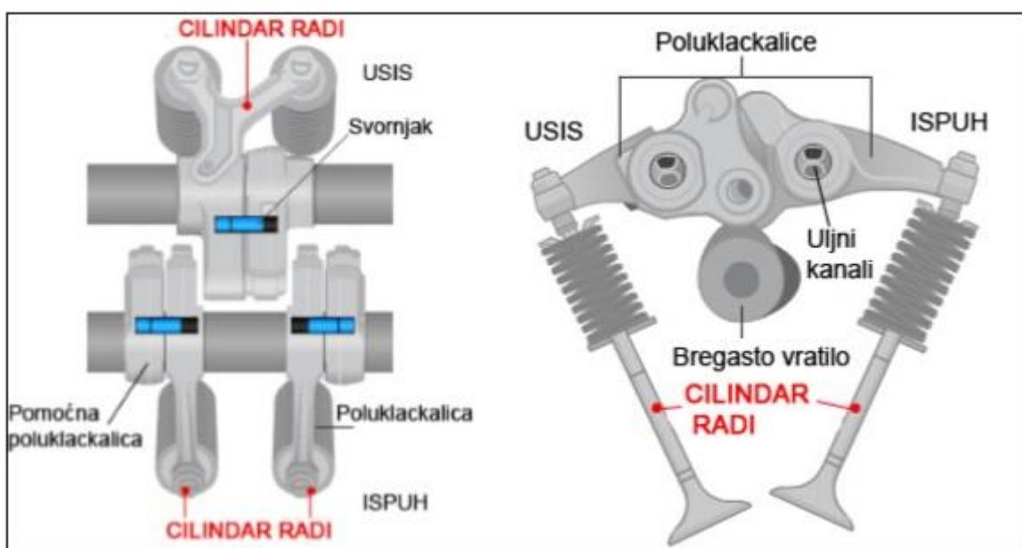
Slika 2. Sustav pomičnih poluklackalica (cilindri su uključeni) [3]
