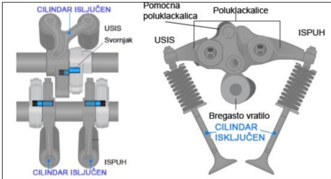
Slika 3. Sustav pomičnih poluklackalica (cilindri su isključeni) [3]
