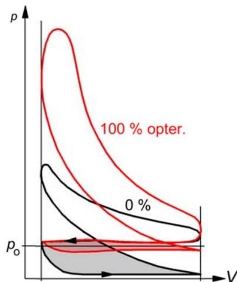
**Slika 1. Indikatorski dijagram Ottovog motora kod punog opterećenja (100 %) i u praznom hodu (0 %) [2]**
