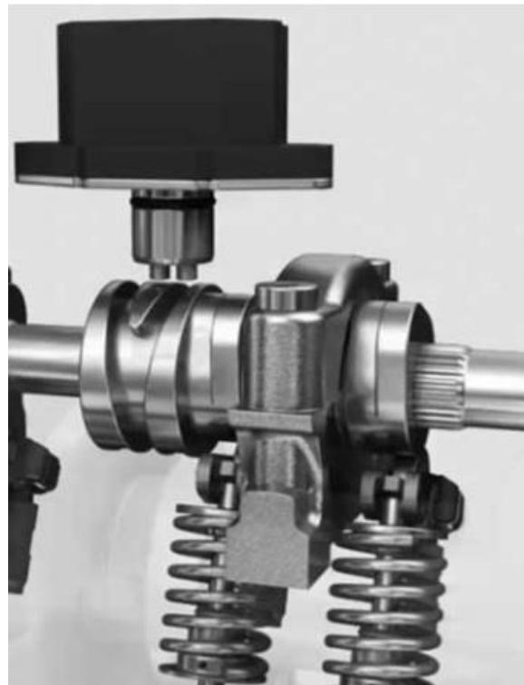
**Slika 4. Dvostupanjski sustav s pomičnim brijegom bregastog vratila [1]**
