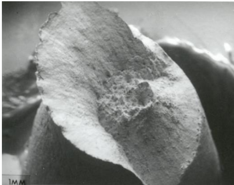
Slika 6. Tipičan duktilni lom završen konusnim smicanjem [5]
