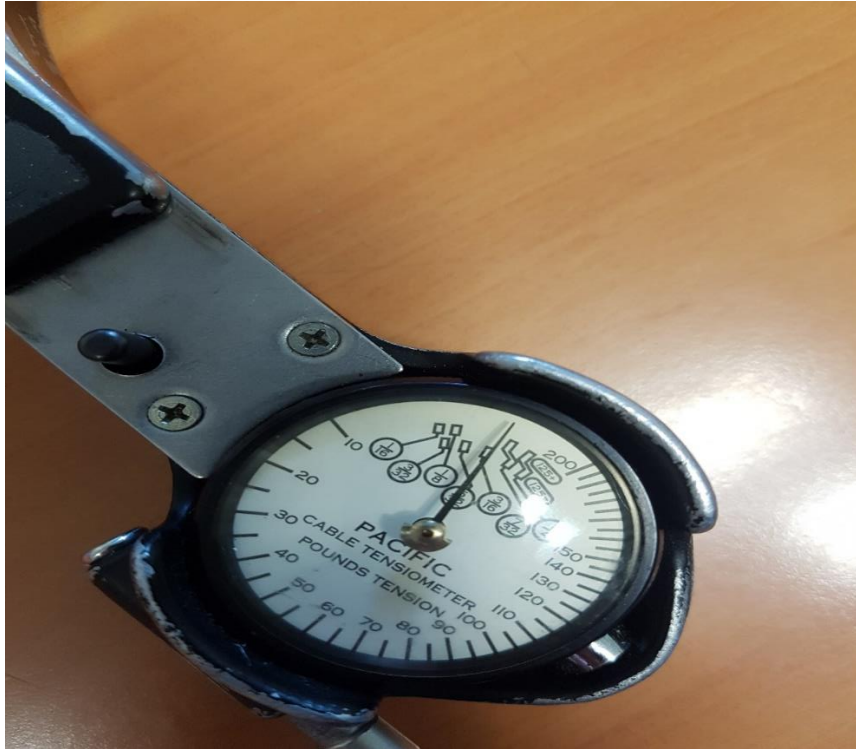
Slika 22. Mjerna skala tenzometra T60 tipa C8
