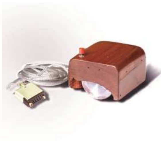
Slika 2. Prototip miša Douglasa Engelberta
