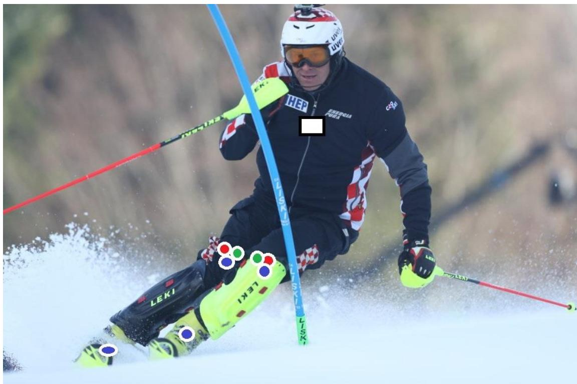
Slika 27. Položaji senzora u konceptualnom skijaškom mehatroničkom sustavu
