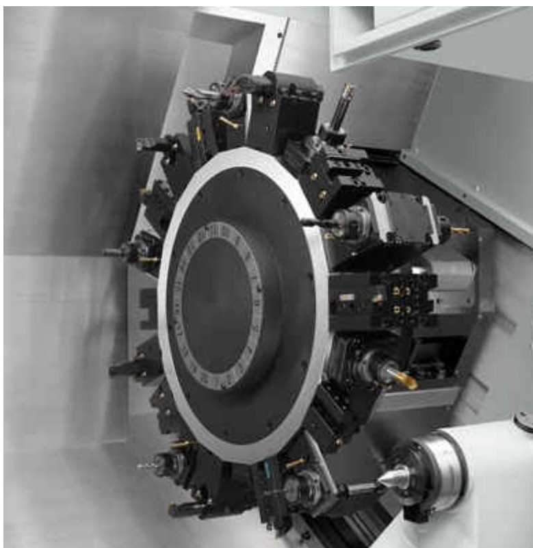
Slika 21. Revolverska galava s 20 alata [13]
