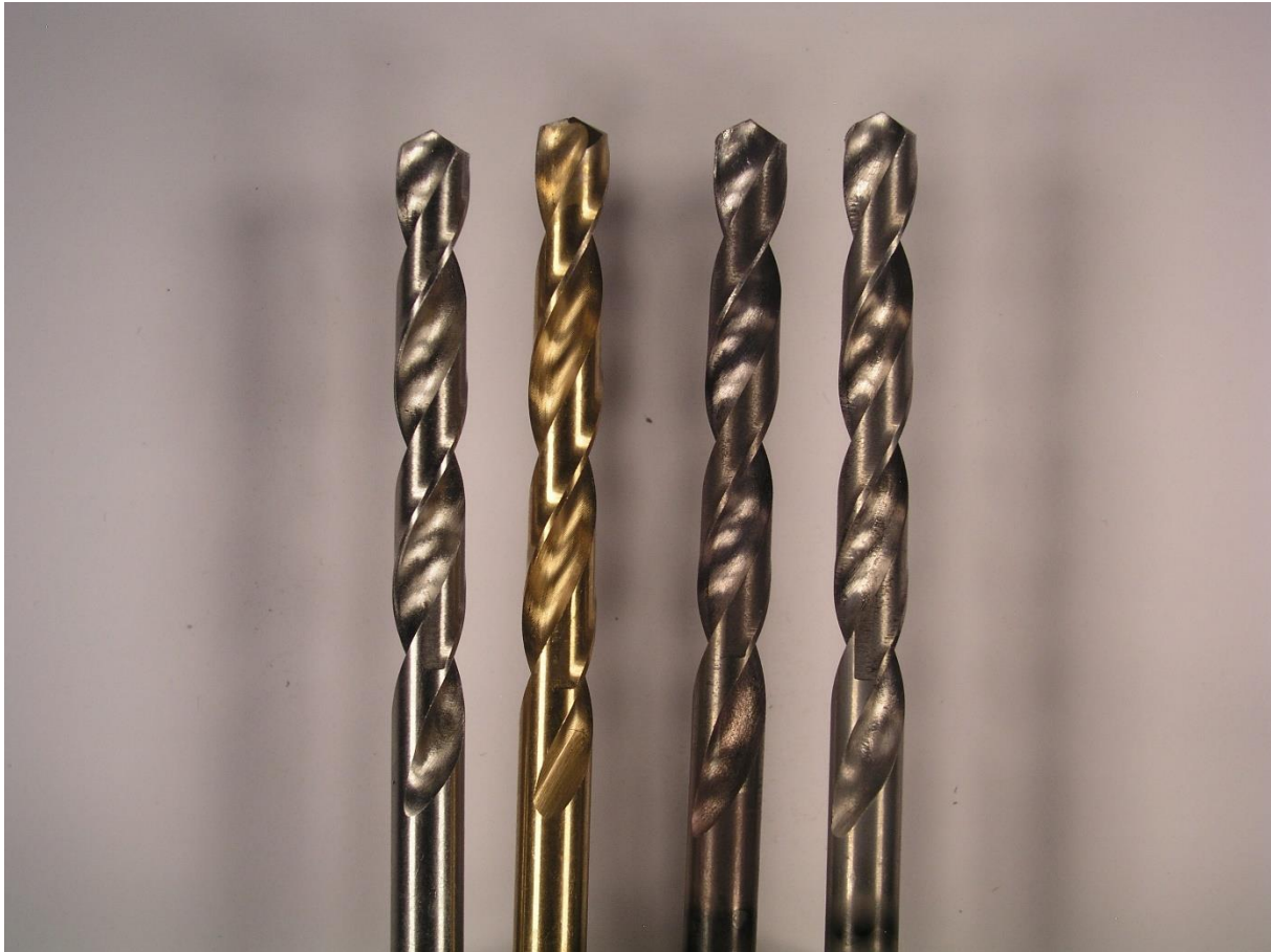
Slika 27. Stanje vršnih kutova nakon provedenog pokusa
