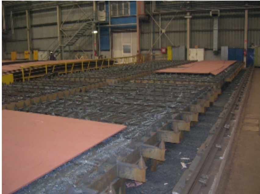
Slika 20. Stol za rezanje acetilen kisikom
