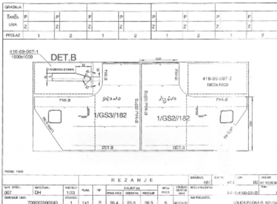
Slika 31. Radni list iz odjela numeričkog trasiranja sa prikazom kontrolnih dimenzija
