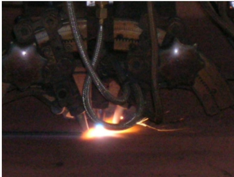
Slika 21. Glava OXY stroja sa tri glave za rezanje
