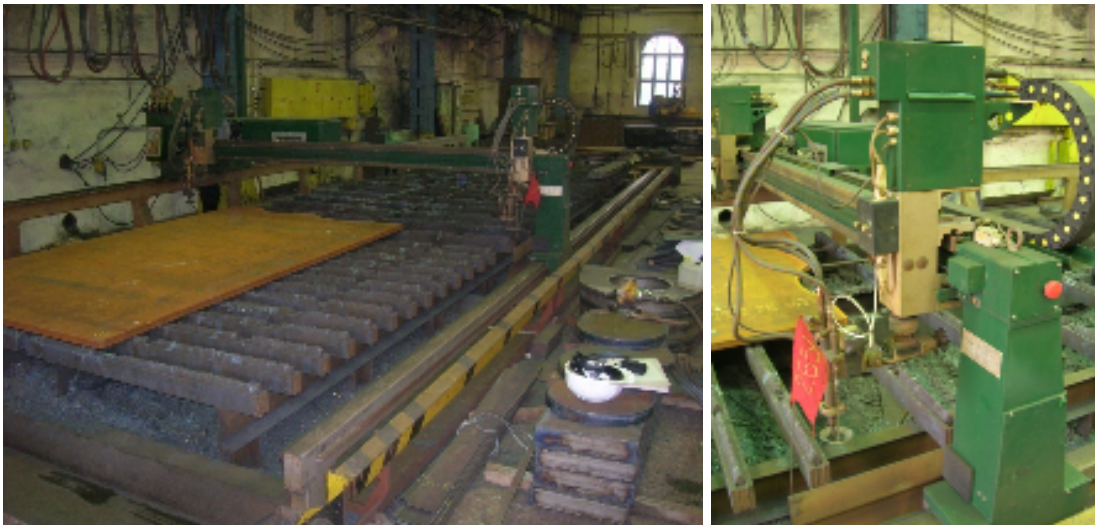
Slike 44. i 45. Stroj za rezanje acetilen kisikom „Ivana 30“
