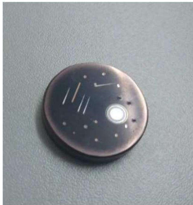
**Slika 31.** Uzorak prevučen TiAlSiN prevlakom
