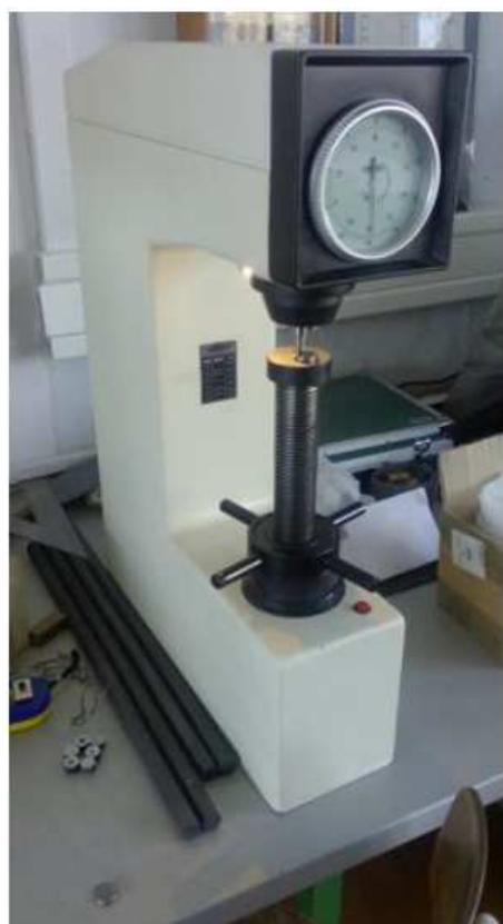
Slika 34. Trvdomjer za ispitivanje prionjivosti prevlaka
