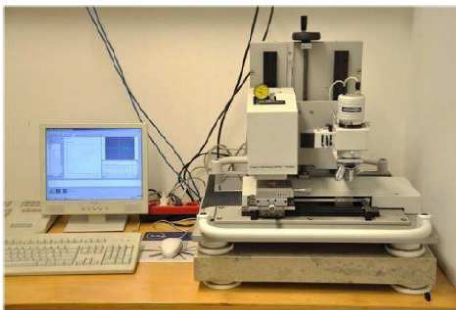
Slika 39. Tvrdomjer Vickers Helmut Fisher Fisherscope H100C za mjerenje tvrdoće prevlaka
