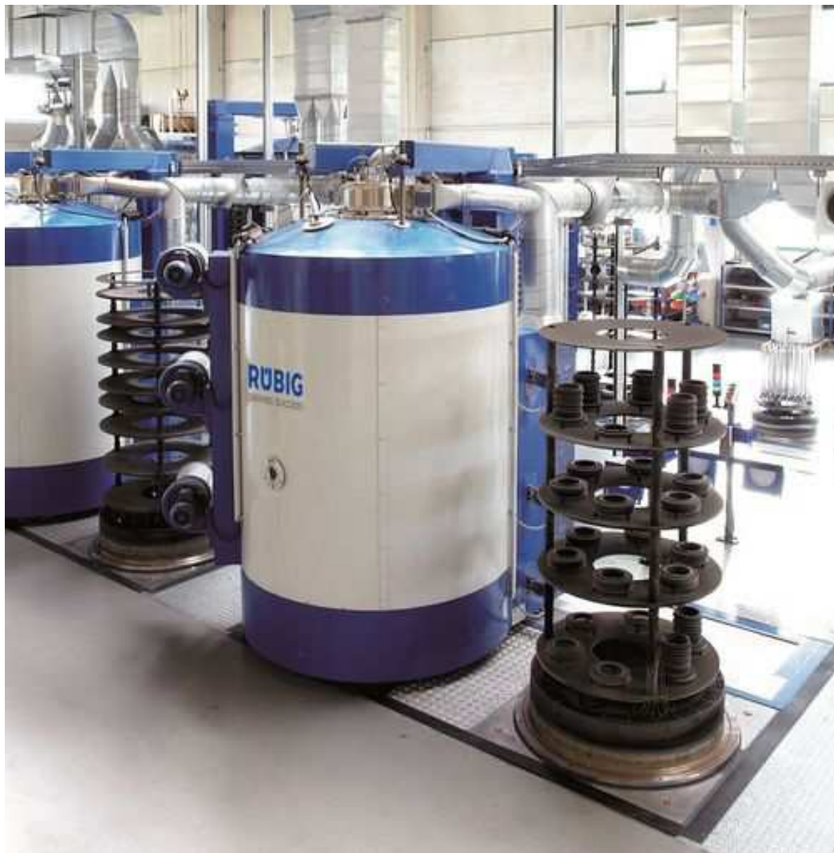
Slika 11. PACVD sustav tvrtke Rübige iz Austrije [22]
