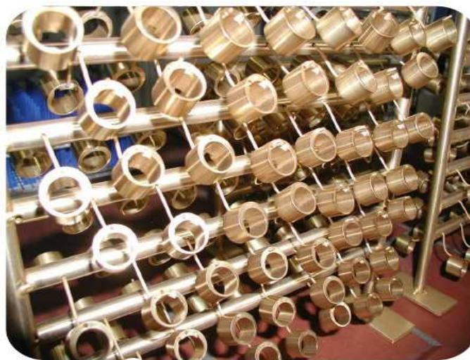
Slika 13. Prevučeni konstrukcijski dijelovi [29]
