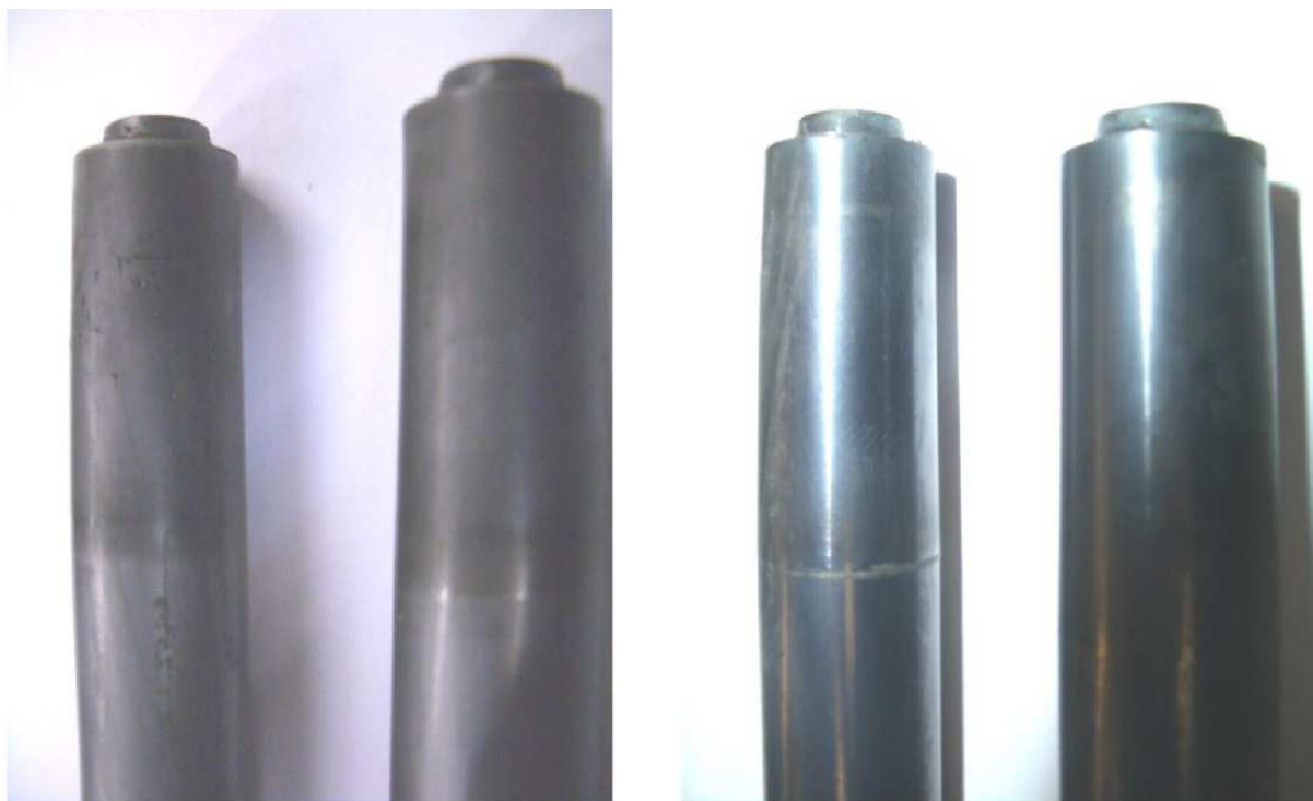
Slika 19. Umetci za izbacivanje otpreska kalupa za injekcijsko prešanje prevučeni TiAlN (lijevo) i TiAlSiN (desno) prevlakom [36]
