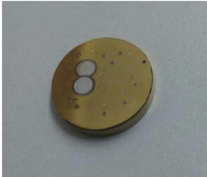
**Slika 30. Uzorak prevučen TiN prevlakom**
