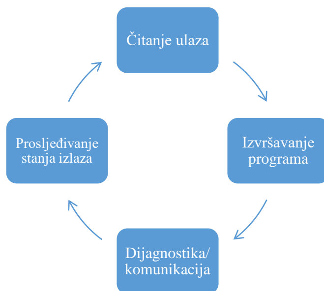
Slika 48. - Cikličko izvršavanje upravljačkog koda i pridruženih operacija PLC-a
