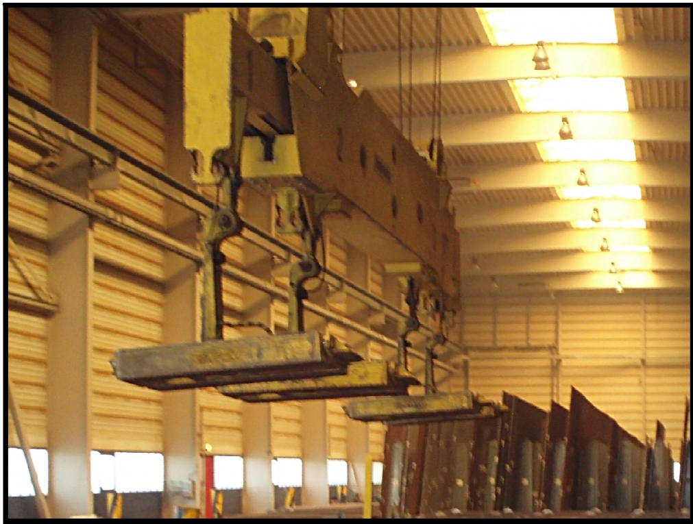
Slika 25. – Primjer grede sa magnetima za nagnjanje limova
