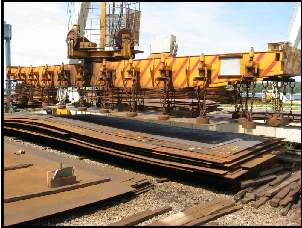
Slika 5. – Roštilj sa magnetima na magnetnoj dizalici
