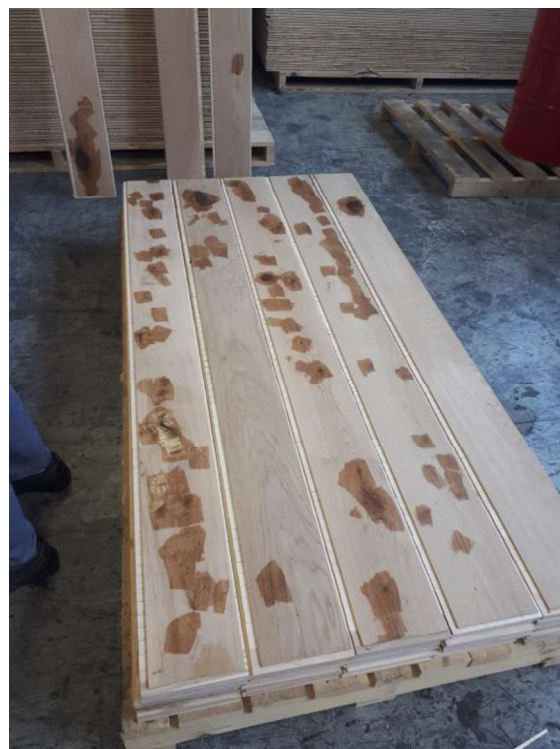
Slika 6. Parket složen na paletu nakon nanošenja punila
