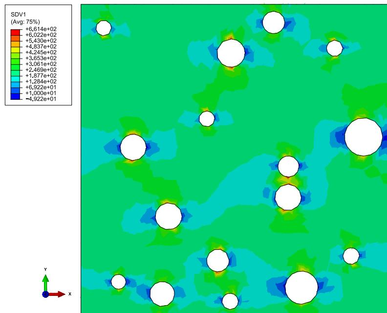
Slika 5.14 Raspodjela normalnog naprezanja za RVE Tundish\_1\_max\_1
