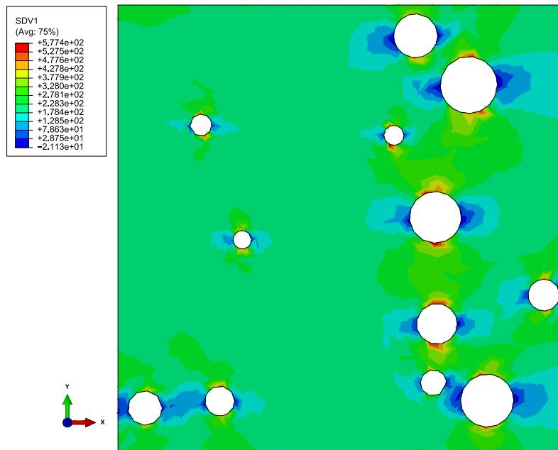
Slika 5.7 Raspodjela normalnog naprezanja za RVE Inmould\_1\_max\_1
