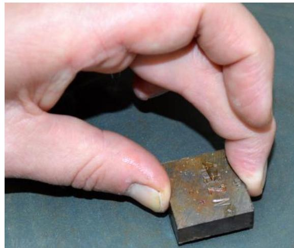
Slika 4.1 Priprema uzorka za metalografsku analizu [15]
