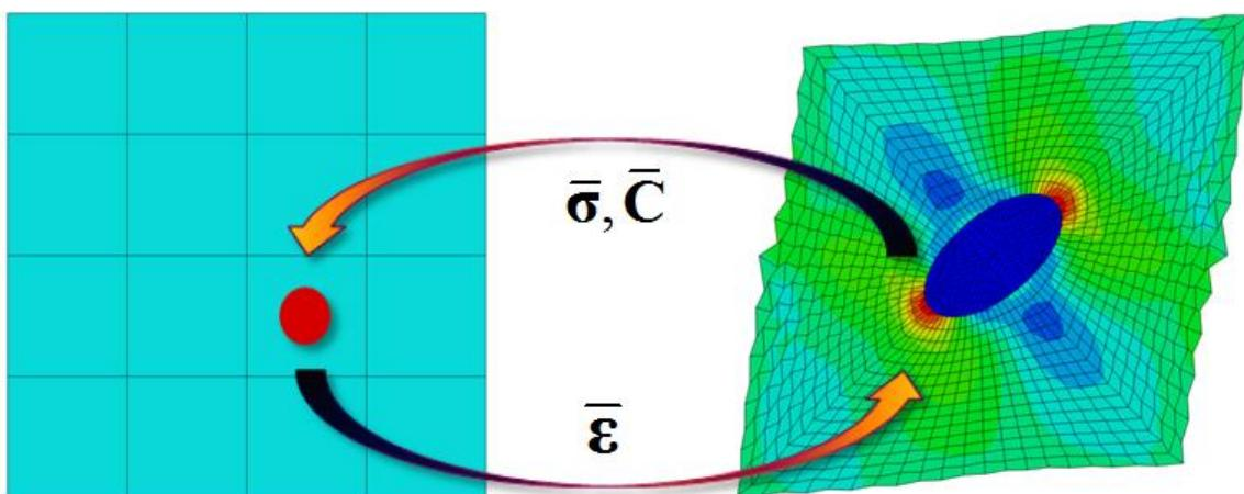
Slika 3.3 Shema Računalne homogenizacije prvog reda [1]
