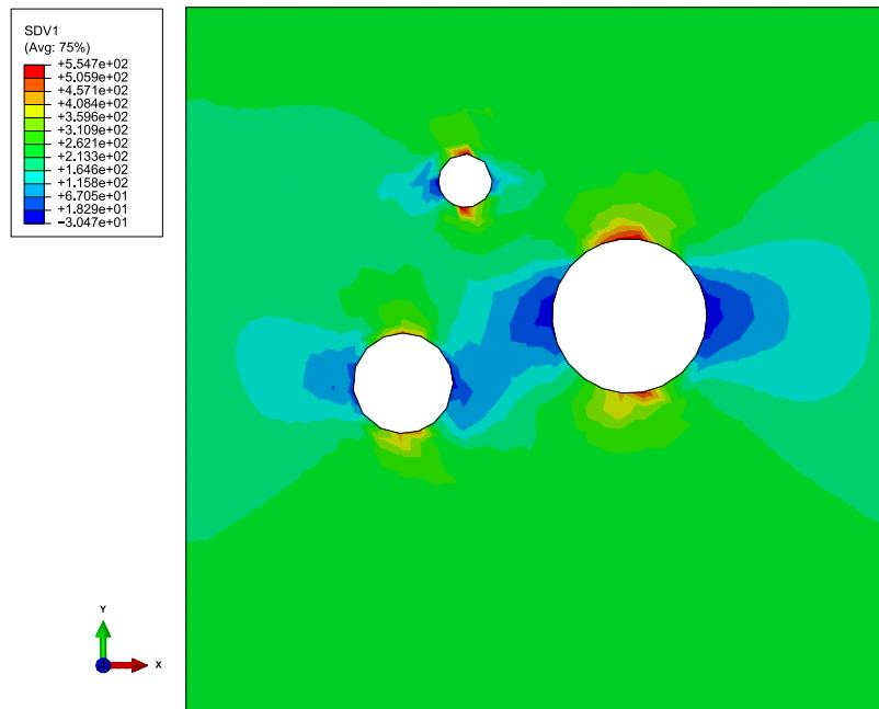
Slika 5.12 Raspodjela normalnog naprezanja za RVE Tundish\_1\_min\_1
