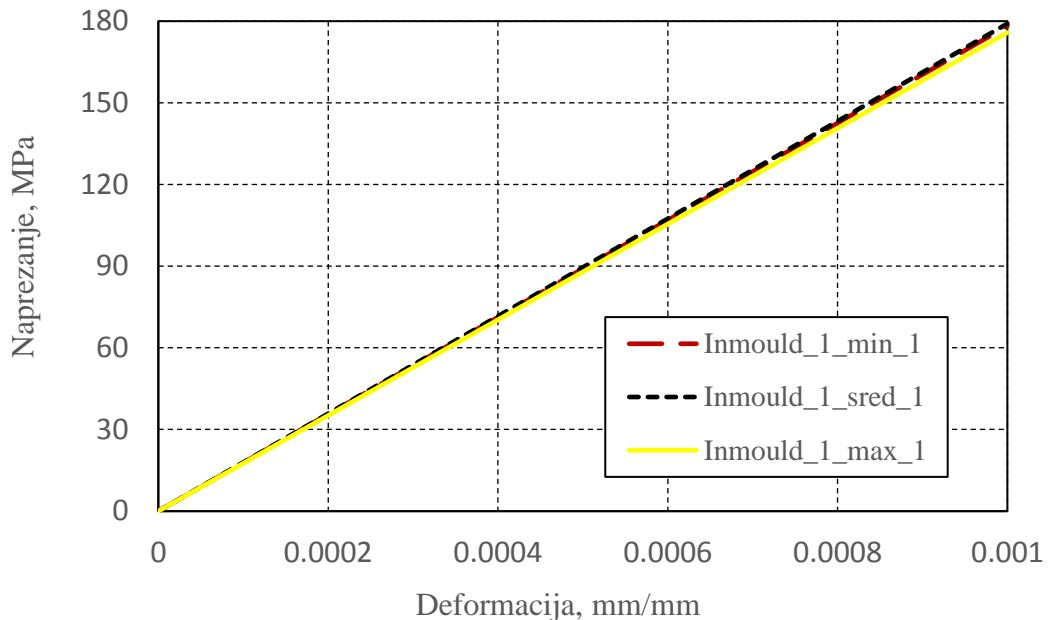
Slika 5.1  $\sigma - \varepsilon$  dijagram za slučaj tri RVE –a: Inmould\_1\_min\_1, Inmould\_1\_sred\_1 i Inmould\_1\_max\_1
