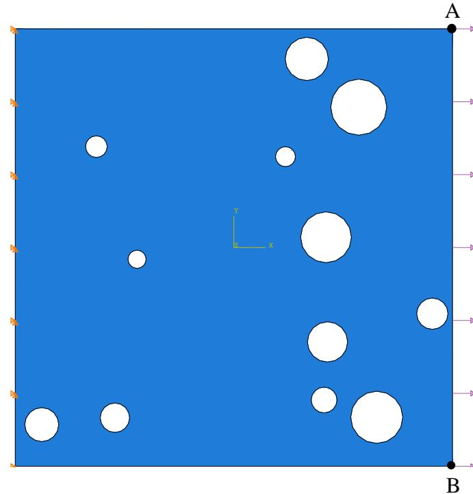
Slika 4.14 Proračunski model vlačnog testa, RVE Tundish\_1\_max\_1
