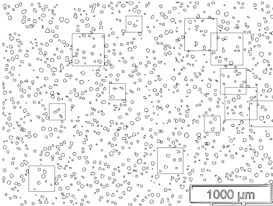
Slika 4.4 Položaji RVE – ova za slučaj mikrostrukture Inmould\_2
