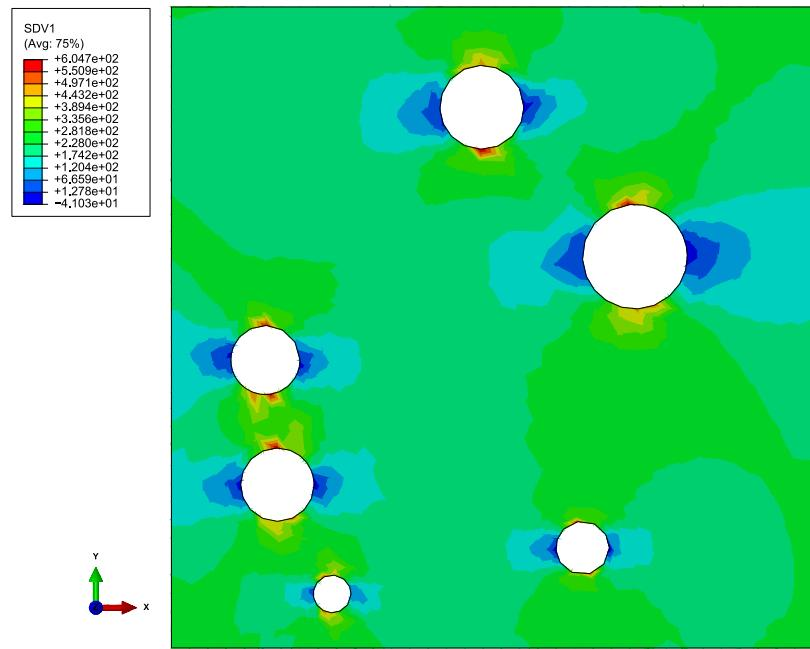
Slika 5.13. Raspodjela normalnog naprezanja za RVE Tundish\_1\_sred\_1
