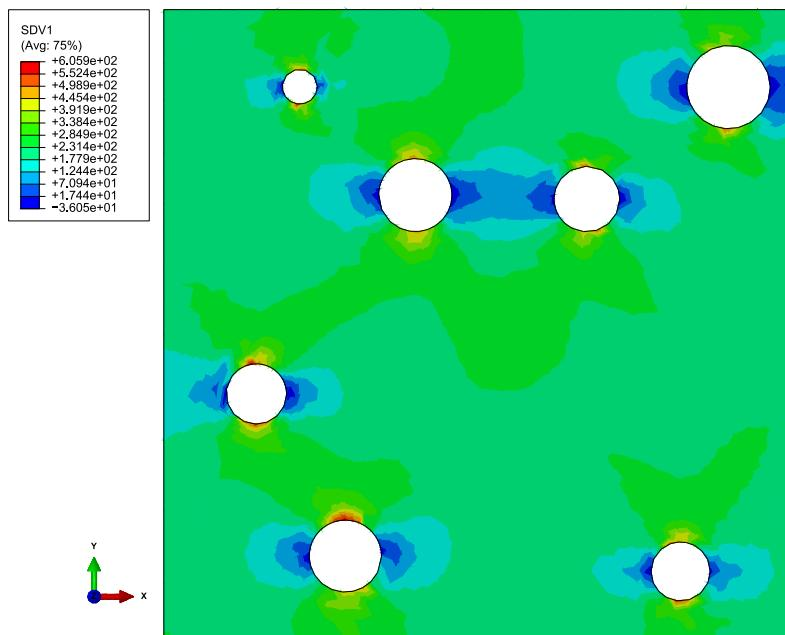
Slika 5.6 Raspodjela normalnog naprezanja za RVE Inmould\_1\_sred\_1
