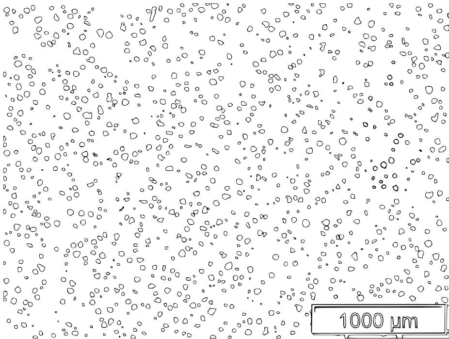
Slika 4.3 Mikrostruktura nodularnog lijeva nakon obrade u programskom paketu CorelDRAWX6, Inmould\_2
