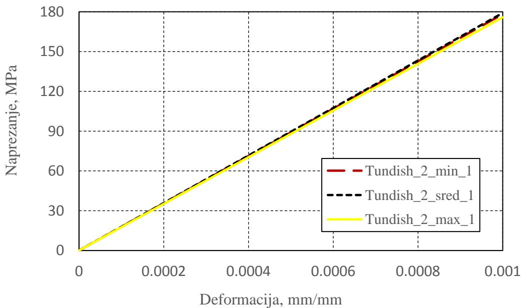
Slika 5.10  $\sigma - \varepsilon$  dijagram za slučaj tri RVE – a: Tundish\_2\_min\_1, Tundish\_2\_sred\_1 i Tundish\_2\_max\_1
