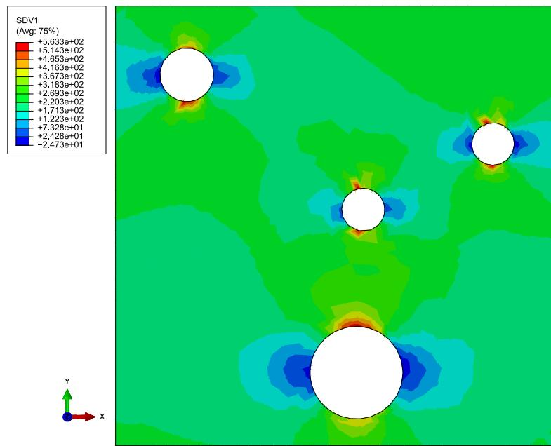
Slika 5.5 Raspodjela normalnog naprezanja za RVE Inmould\_1\_min\_1
