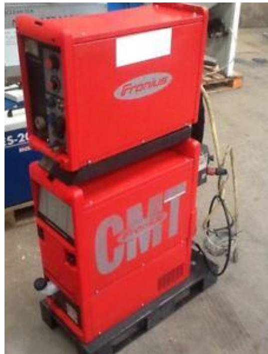
*Slika 18. Izvor struje za zavarivanje Synergic 4000 CMT R*
