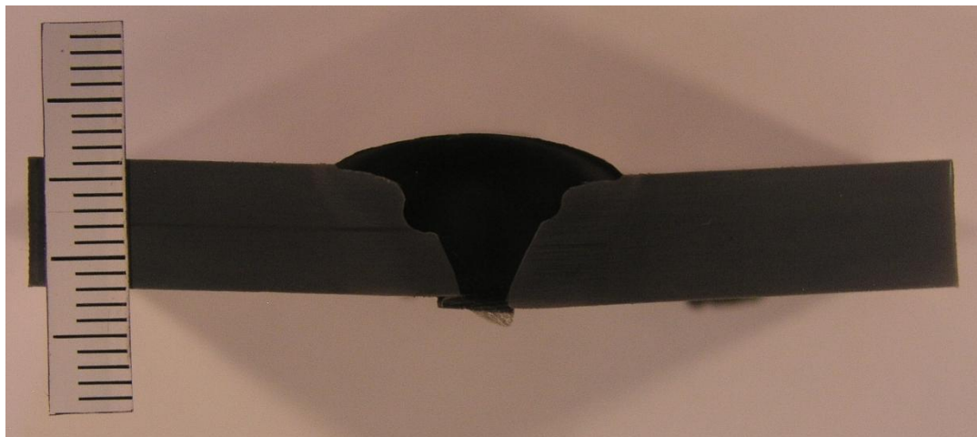
Slika 34. Uzorak 2 – sučeoni spoj
