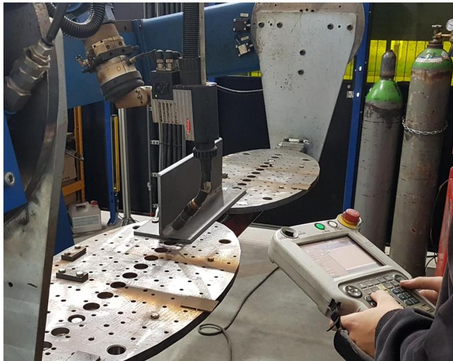
*Slika 22. Programiranje robota za zavarivanje*
