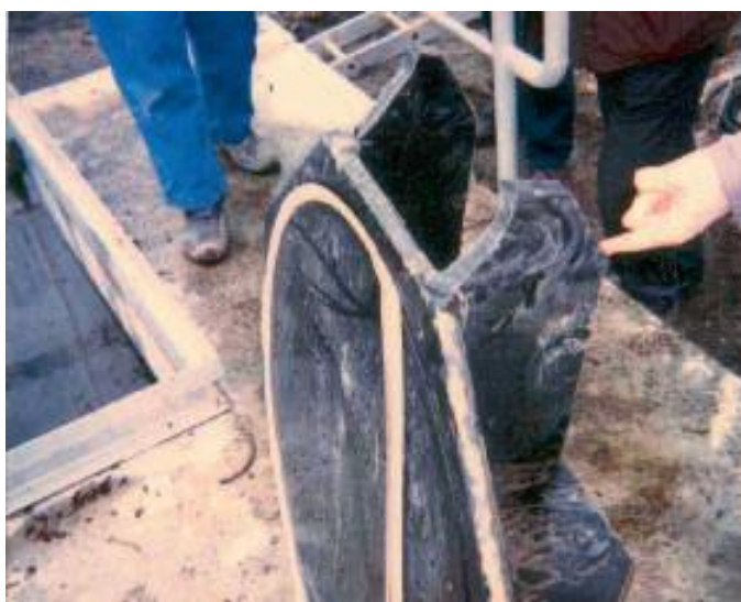
Slika 8. Oštećenje nepovratnog ventila zbog hidrauličkog udara [3]
