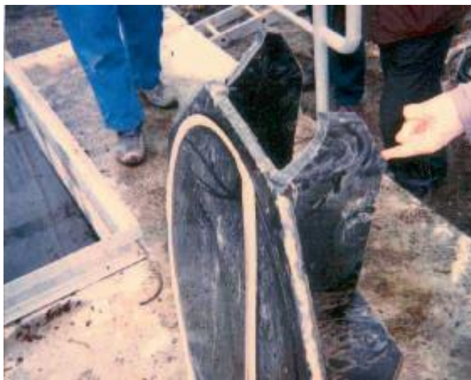
Slika 8. Oštećenje nepovratnog ventila zbog hidrauličkog udara [3]
