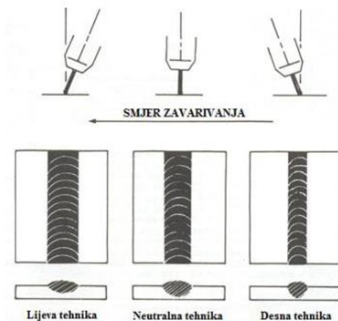
Slika 9. Tehnike rada kod MIG/MAG zavarivanja [21]
