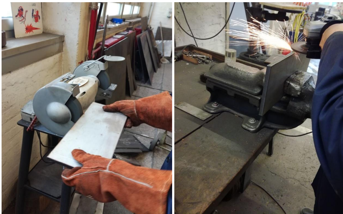
Slika 29. Lijevo - Grubo brušenje na stolnoj brusilici; Desno - Završna fina obrada kutnom brusilicom
