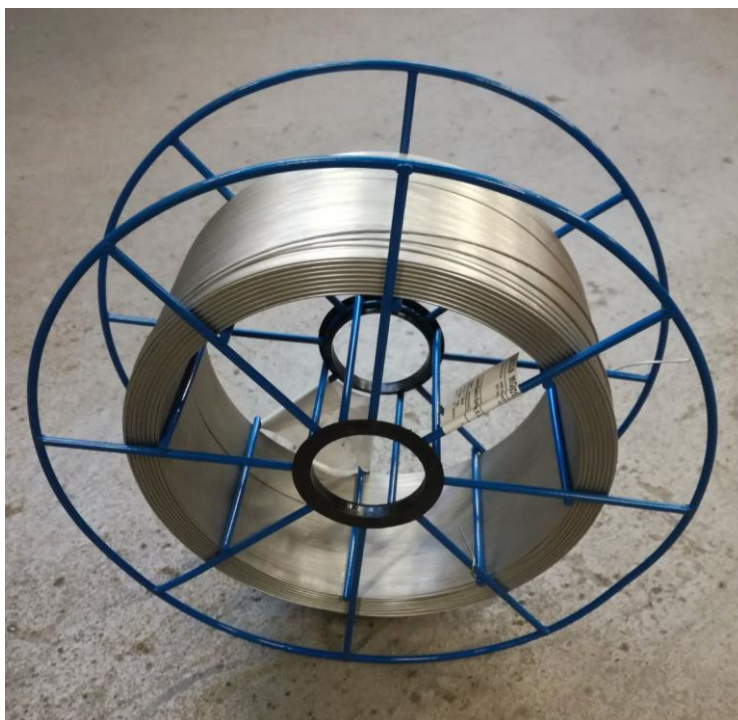
Slika 31. Žica od austenitnog čelika (AISI 309)
