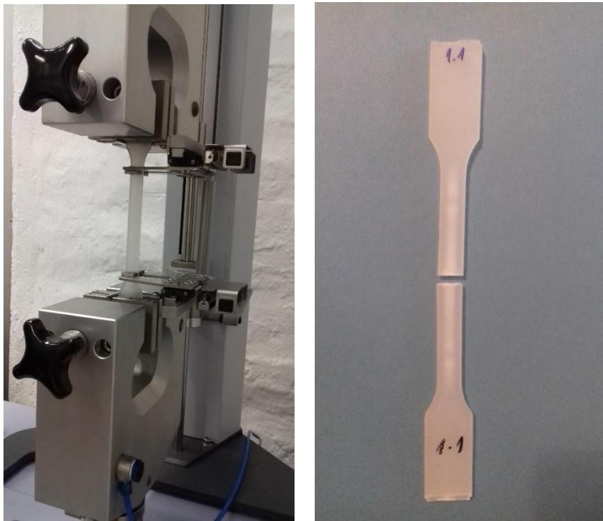
Slika 7.14: a) Kidanje ispitnog tijela b) Lom ispitnog tijela na liniji spoja
