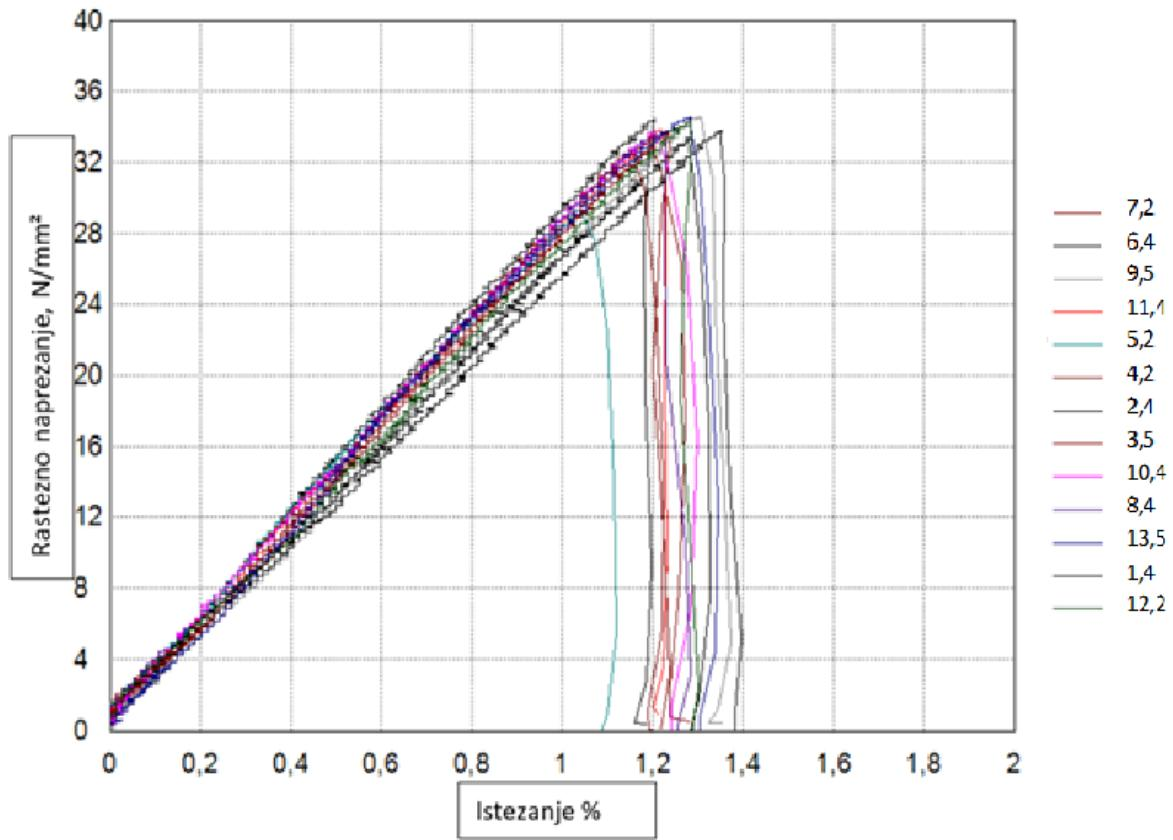
Slika 7.18: Dijagram rasteznog naprezanja – istezanja za PS – na dijagamu su prikazane linije samo od jednog ispitnog tijela po stanjima pokusa
