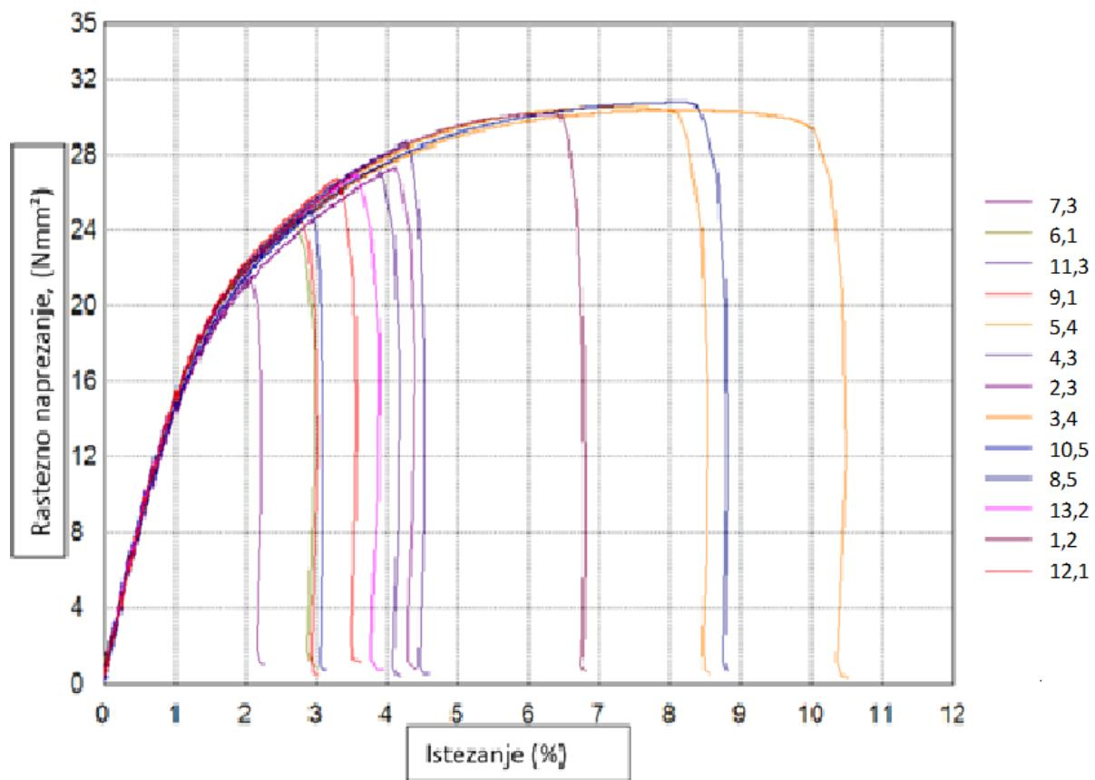
Slika 7.15: Dijagram rastezno naprezanja – istezanja za PP – na dijagramu su prikazane linije samo od jednog ispitnog tijela po stanjima pokusa
