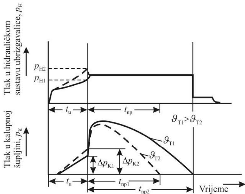
Slika 3.5: Utjecaj temperature taljevine na tijek hidrauličkog tlaka i tlaka u kalupnoj šupljini:  $\vartheta_T$  - temperatura taljevine,  $t_u$  - vrijeme ubrizgavanja [5,6]
