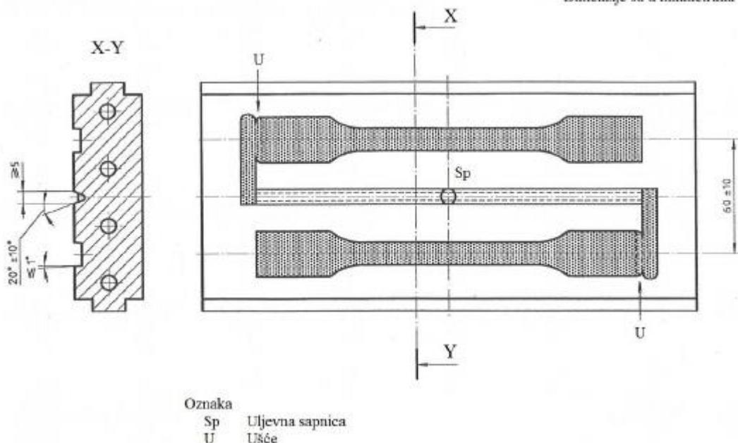
Slika 4.1: Kalupna ploča za ISO kalup tip A [6]
