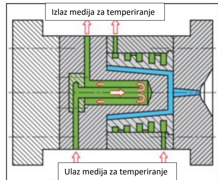
Slika 3.10.: Primjer sustava kanala za temperiranje [8]
