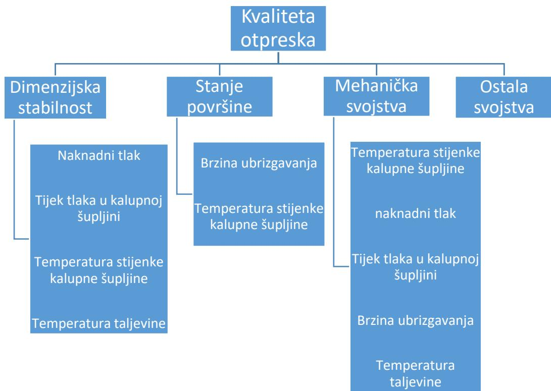
Slika 3.12.: Veza pojedinih parametara procesa s kvalitetom otpreska [6]
