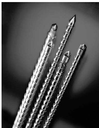
Slika 2.3 : Razne izvedbe pužnih vijaka [3]
