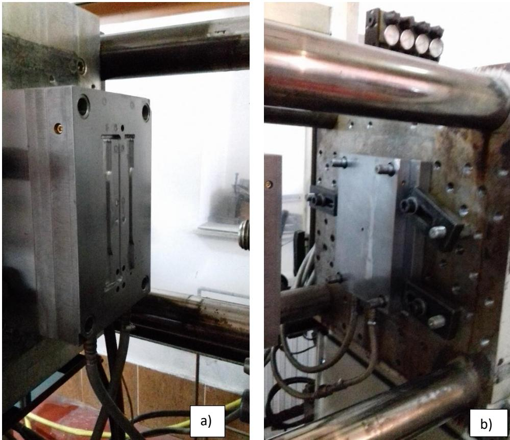
Slika 7.5: a) Pomični dip kalupa s C konfiguracijom b) Nepomični dio kalupa
