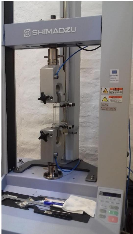
Slika 7.7: SHIMADZU kidalica
