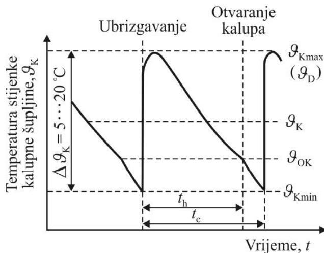
Slika 3.6.: Temperaturno polje u kalupu:  $\vartheta_K$ - temperatura stijenke kalupne šupljine,  $\vartheta_D$  – dodirna temperatura,  $\vartheta_{OK}$ - temperatura otvaranja kalupa,  $t_c$ - vrijeme ciklusa injekcijskog prešanja,  $t_h$ - vrijeme hlađenja otpreska [5,6]
