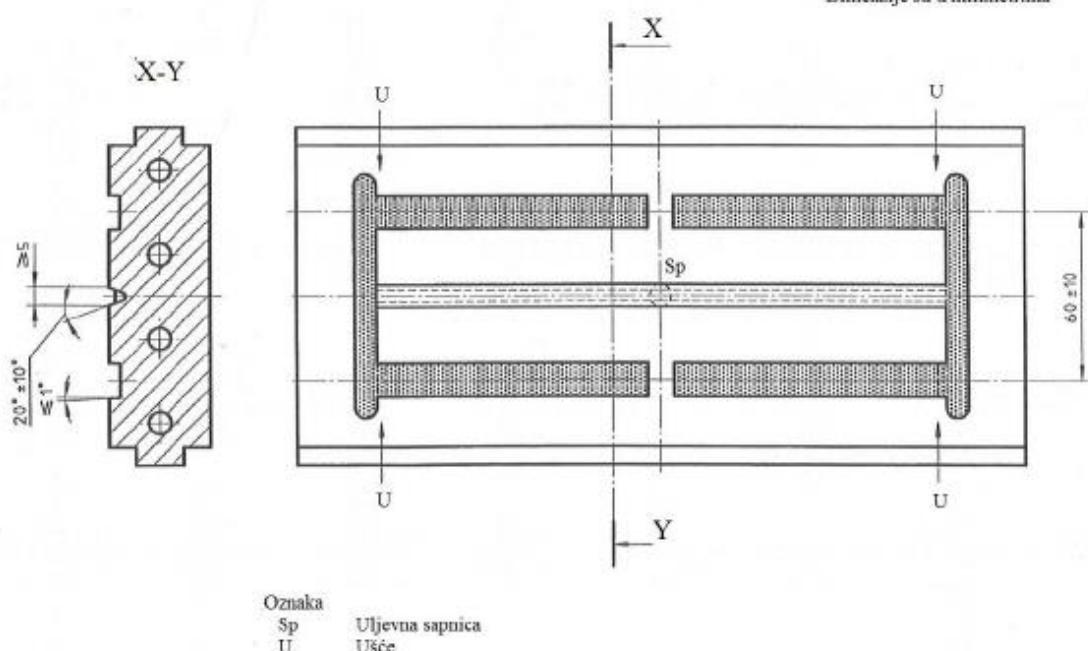
Slika 4.2: Kalupna ploča, B tip ISO kalupa [6]
