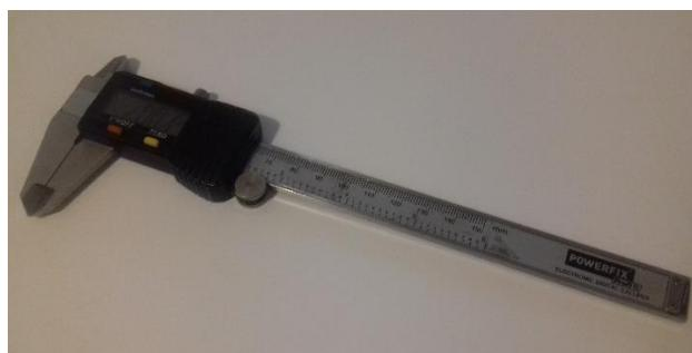
Slika 7.6: Powerfix digitalna pomična mjerka
