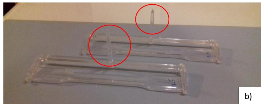
Slika 7.16: a) Ostatak materijala kod uljevnog sustava pri nižim temperaturama u odnosu na više temp (b)
