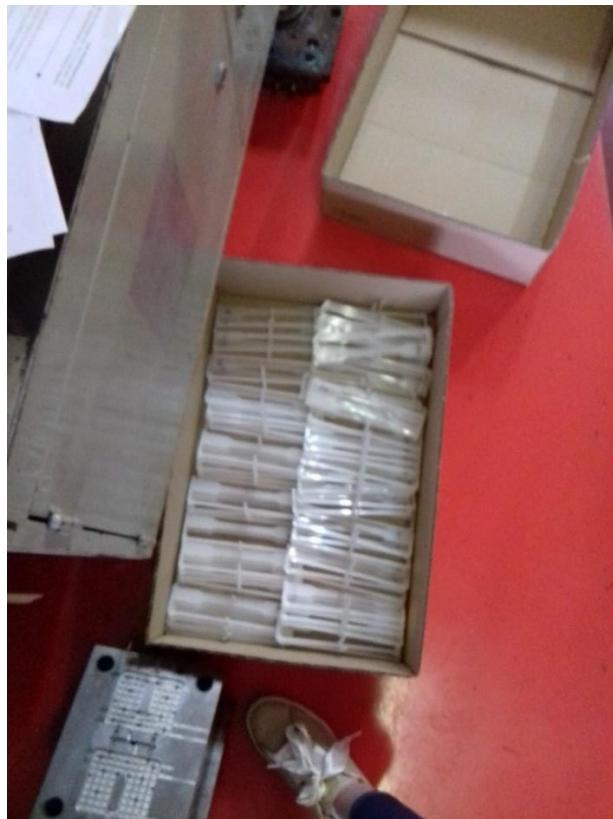
Slika 7.13: Injekcijski isprešana ispitna tijela od polipropilena
