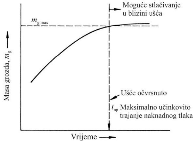
Slika 3.9: Određivanje optimalnog vremena djelovanja naknadnog tlaka [5,6]
